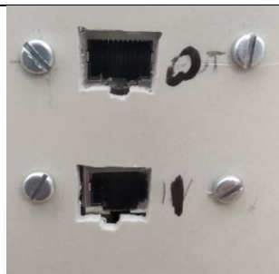
Slika 9. Ugrađeni ulazi/izlazi na linearnom prigonu (korišten je ethernet konektor)
