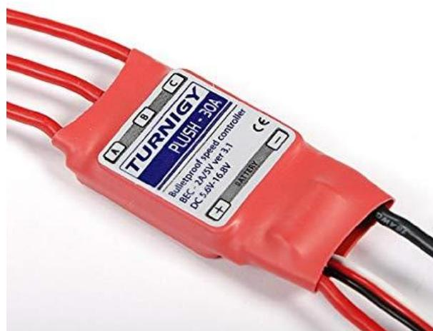
Slika 34. Elektronički kontroler brzine [4]
