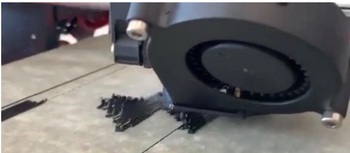
Slika 24. Slabo lijepljenje prvog sloja
