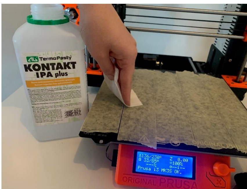
Slika 22. Priprema površine platforme za 3D ispis
