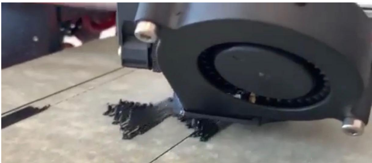
Slika 24. Slabo lijepljenje prvog sloja
