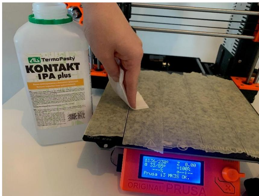
**Slika 22. Priprema površine platforme za 3D ispis**
