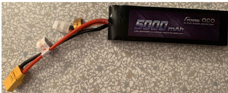
Slika 36. Baterija Gens Ace 5000 mAh, 50 C
