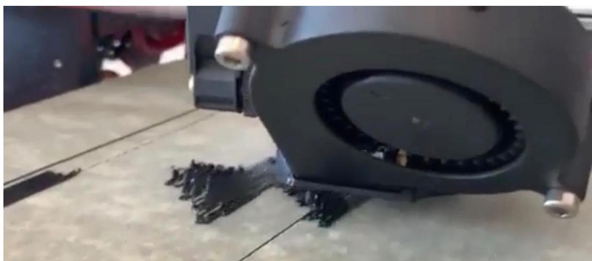
Slika 24. Slabo lijepljenje prvog sloja
