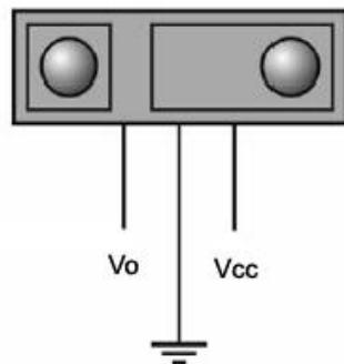
Slika 3.2. Definicije pinova na senzoru GP2D12 [4]
