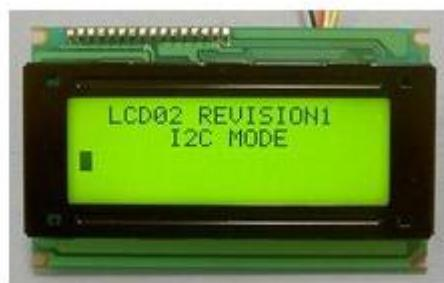
Slika 2.9. LCD ekran na robotu [11]
