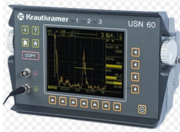
Slika 15. Ultrazvučni uređaj Krautkramer USN60 [7]
