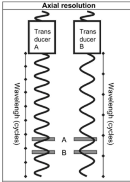
Slika 2. Primjer ovisnosti razlučivosti sonde o frekvenciji [2]
