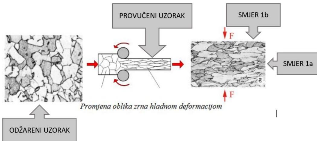
**Slika 17. Mikrostruktura uzorka prije i poslije žarenja te naznačena usmjerenošć zrna**
