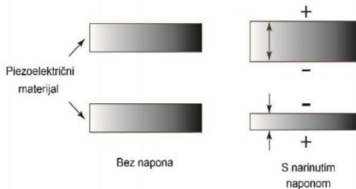
Slika 7. Piezoelektrični efekt [3]
