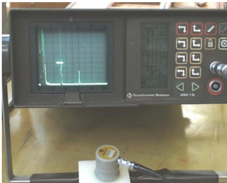
Slika 6. Ultrazvučni uređaj sa pripadnom sondom [1]
