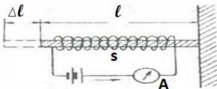
Slika 8. Magnetostriktički efekt [3]
