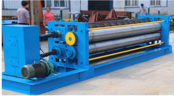
Slika 7. – Stroj za valovito orebrivanje i kalibriranje [5]
