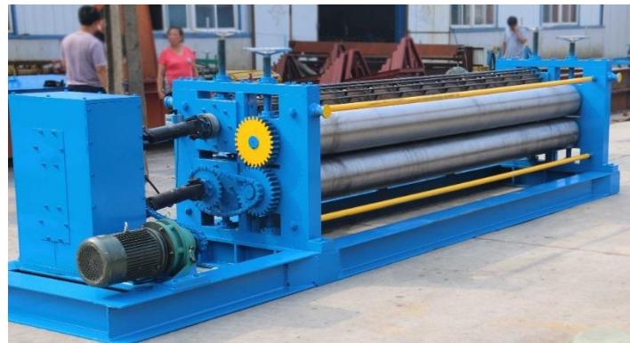
Slika 7. – Stroj za valovito orebrivanje i kalibriranje [5]
