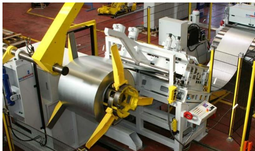
Slika 8. - Stroj za namatanje lima na bubanj [6]
