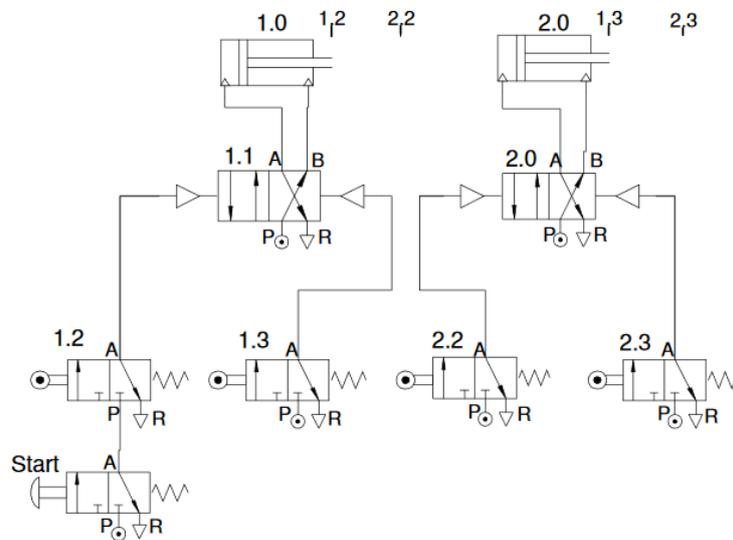
Slika 6. Primjer pneumatske sheme s blokirajućim signalom
