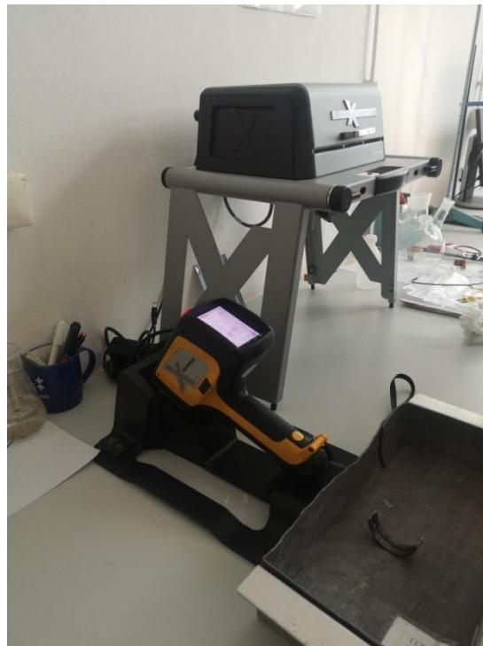
**Slika 22. Prijenosni XRF spektometar**
