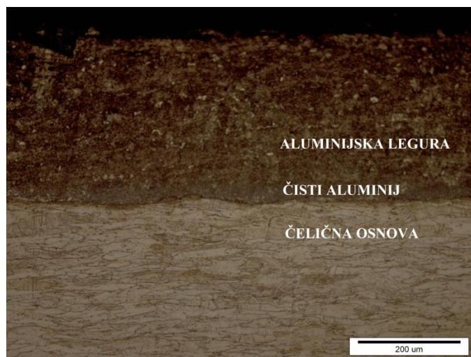
Slika 31. Raspored slojeva na primjeru uzorka 2
