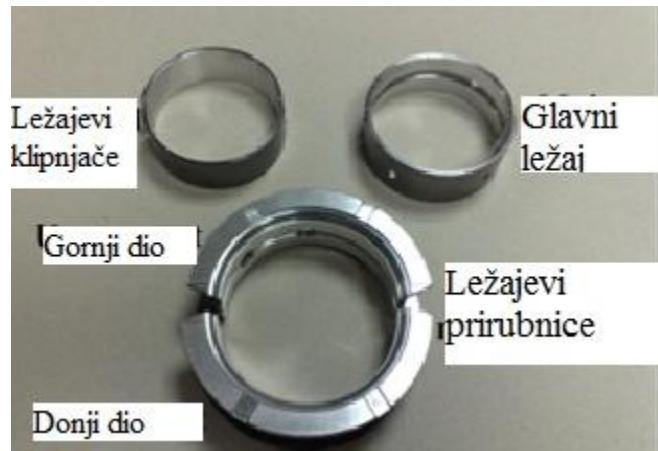
Slika 20. Tipovi i glavni dijelovi ležaja [11]
