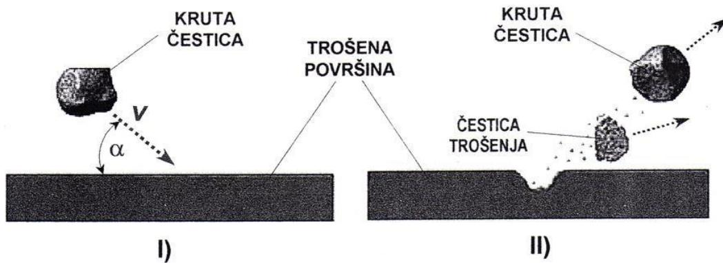
**Slika 13. Jedinični sudara čestice s trošenom površinom [3]**
