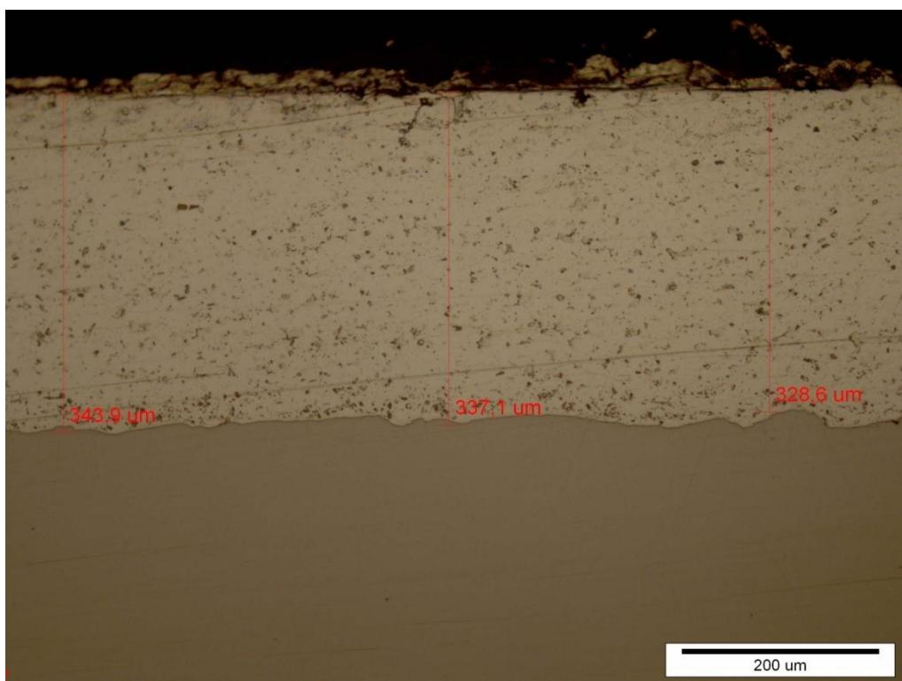
Slika 26. Mikrostruktura u poliranom stanju s dimenzijama sloja uzorka 2,
