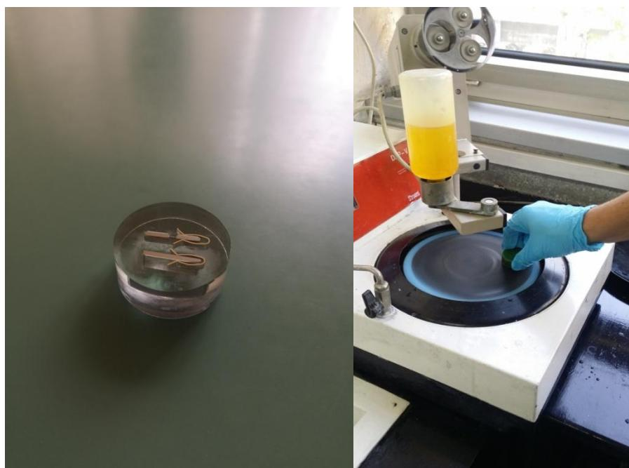
Slika 24. a)Uzorci u polimernoj masi b)naprava za poliranje
