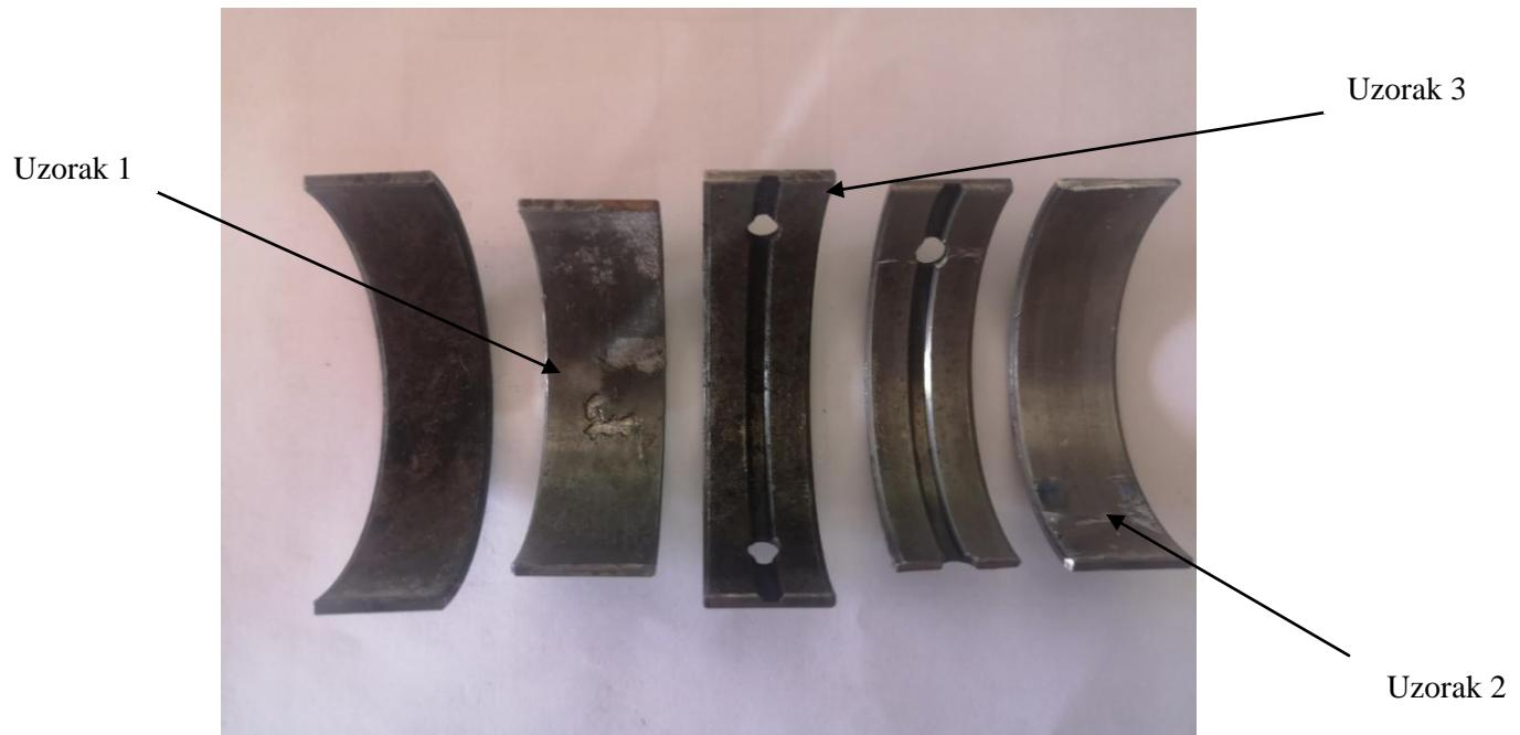
Slika 21. Istrošeni uzorci
