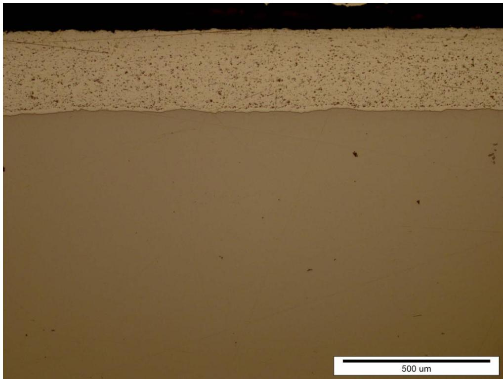
Slika 27. Mikrostruktura u poliranom stanju uzorka 3, povećanje 100x
