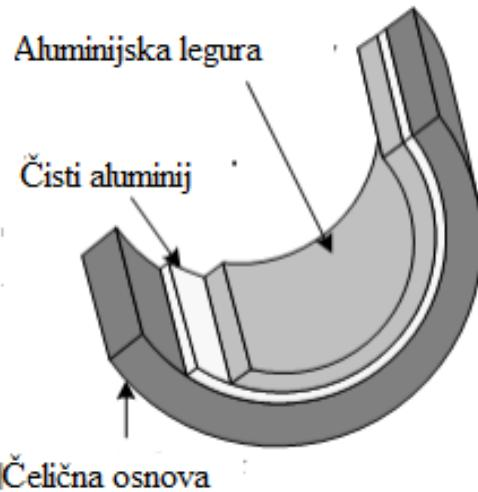
**Slika 32. Dvokomponentni klizni ležaj [13]**
