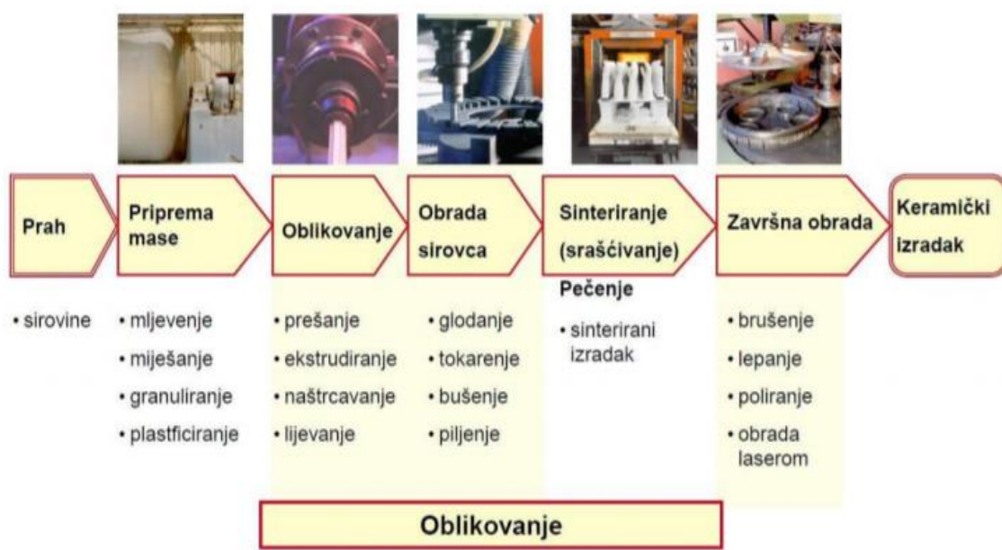
Slika 7. Proces proizvodnje keramike [16]
