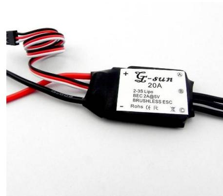
**Slika 8.4. Kontroler za motore**
