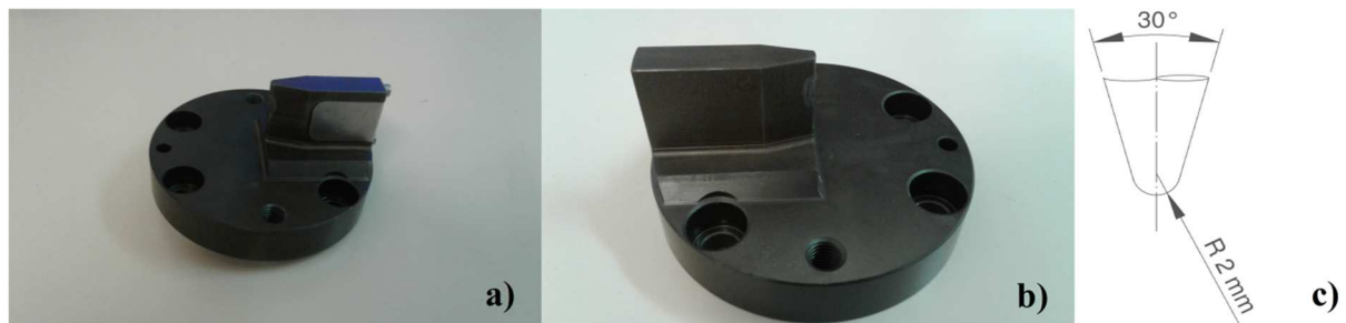
Slika 11. Instrumentirani nož polumjera oštrice 2 mm a); klasični nož polumjera oštrice 2 mm b); geometrija oštrice noža c)
