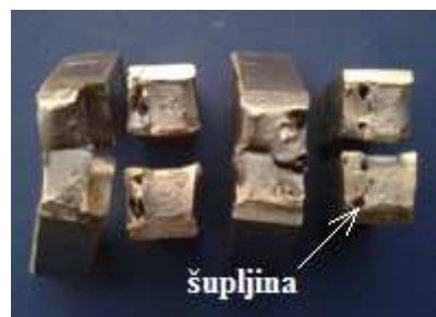
Slika 86. Šupljine unutar metala zavara
