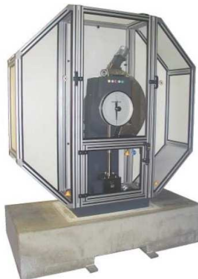
Slika 7. Suvremeni instrumentirani Charpy uređaj [40]
