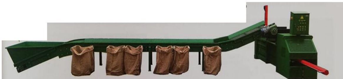
Slika 14. Ručna sortirnica s tri radna mjesta [1]
