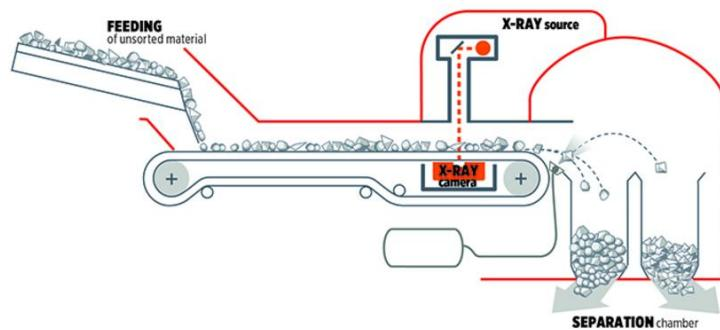
Slika 20. Sortiranje transmisijskim senzorima [8]
