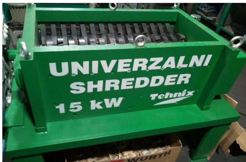
Slika 13. Shredder za RDF kapaciteta 10 t/h
