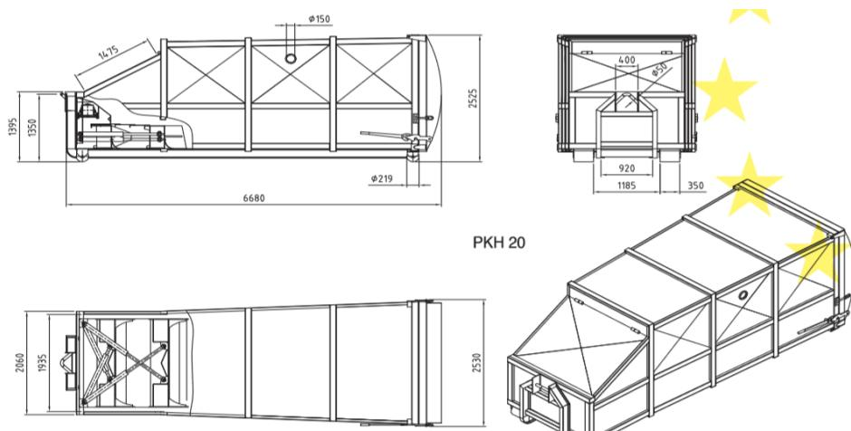
**Slika 3. Hidraulički preskontejner [3]**
