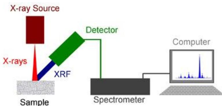
**Slika 21. Shematski prikaz rada flourescentnih senzora [10]**
