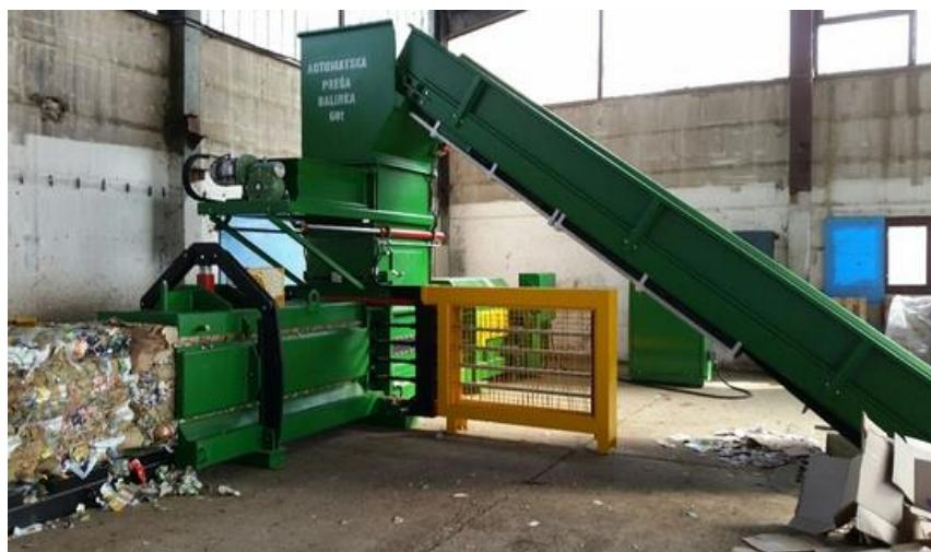
Slika 12. Automatska preša balirka [1]
