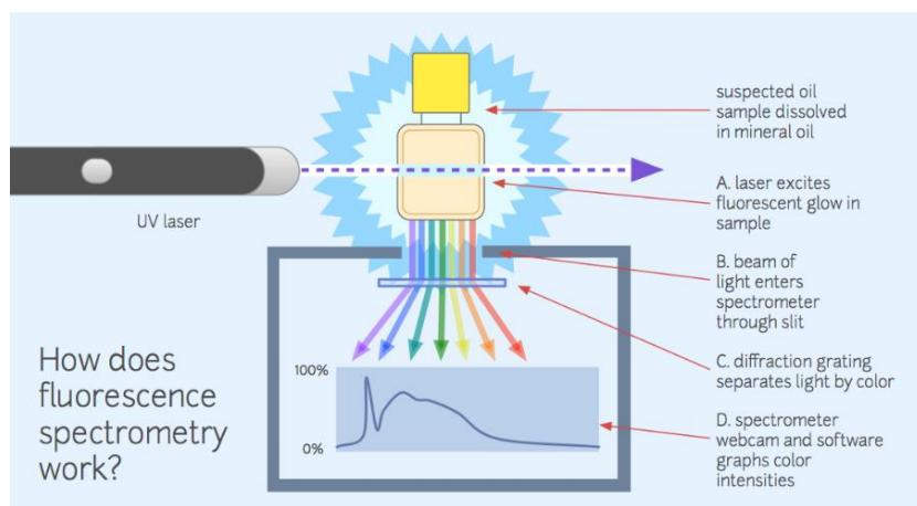
**Slika 23. Princip rada uređaja s VIS senzorima [15]**
