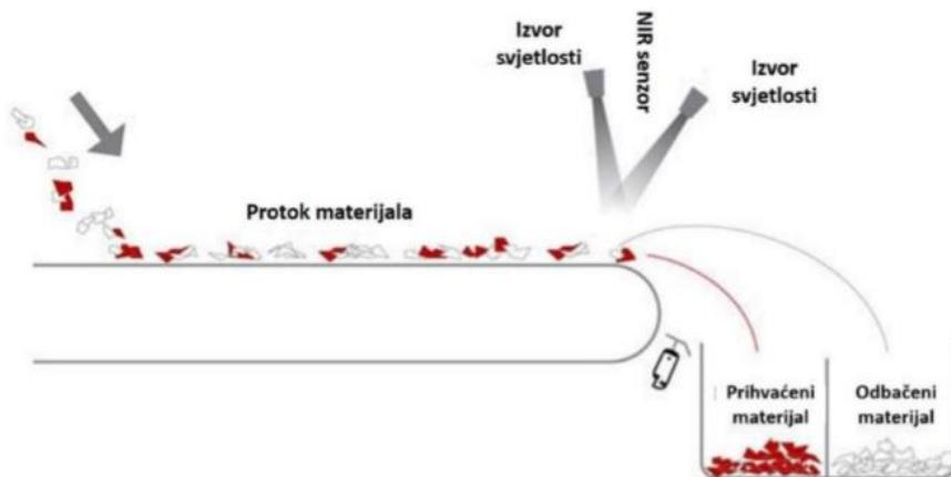
**Slika 22. Princip rada uređaja s NIR senzorima [10]**
