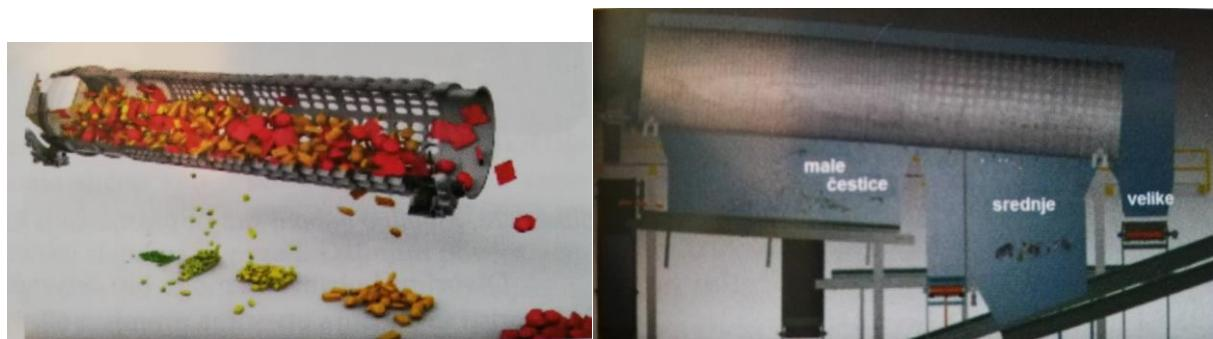
**Slika 10. Shema rotacionog bubenj sita s razdvajanjem na tri i četiri frakcije [4]**
