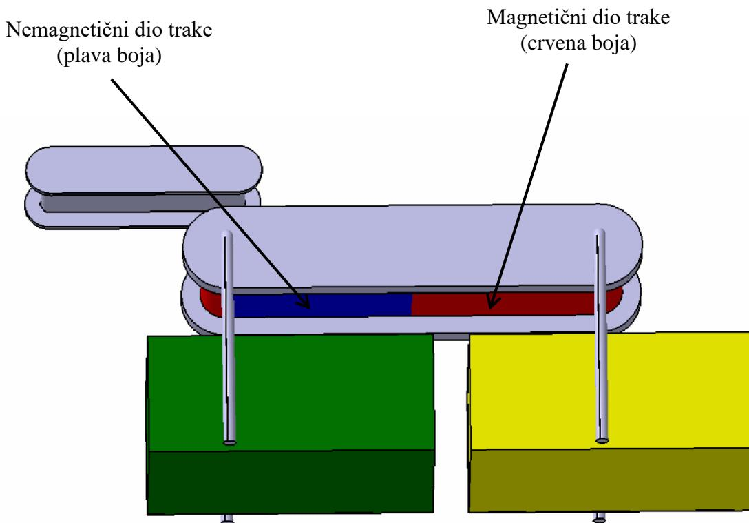
Slika 30. Prikaz magnetičnog i nemagnetičnog dijela trake
