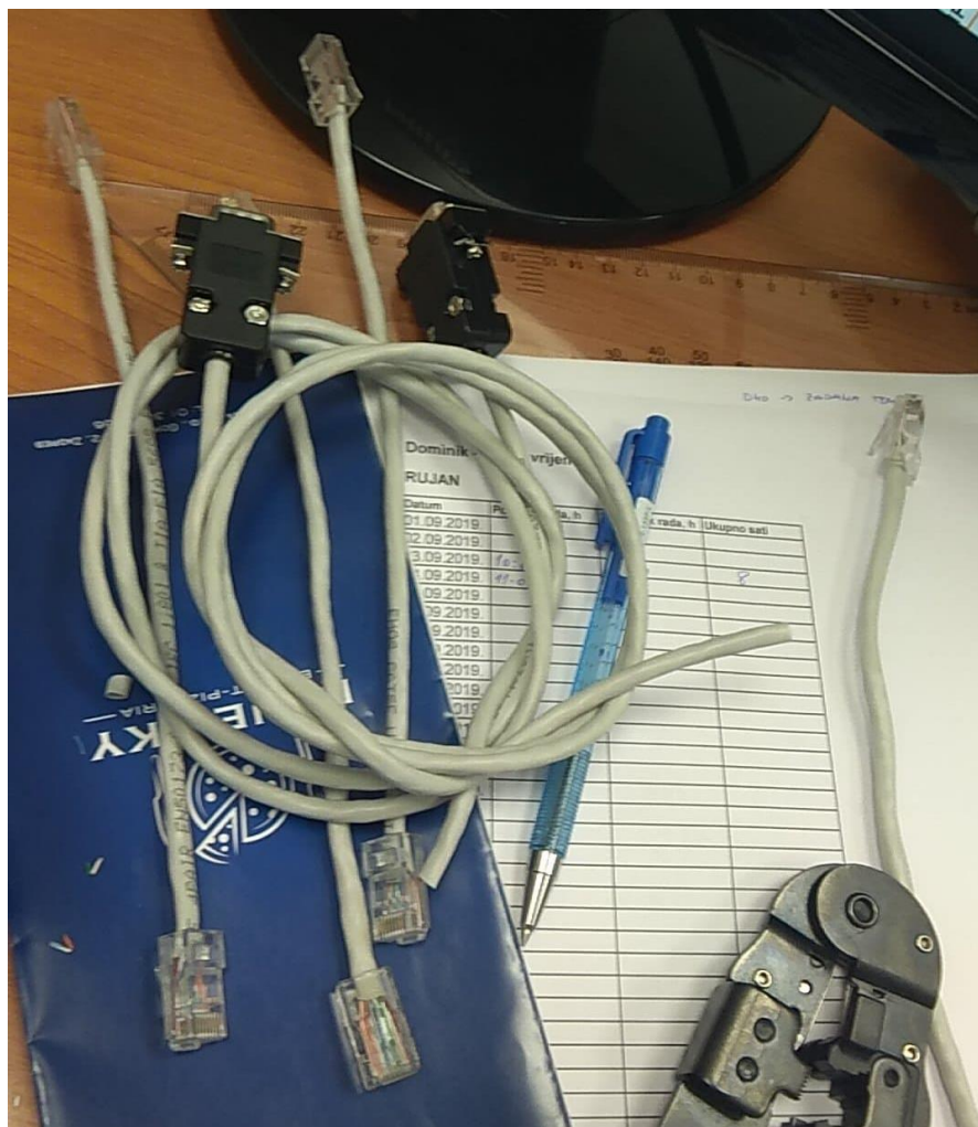
Slika 60. Komunikacijski kabeli za Ethernet i RS422
