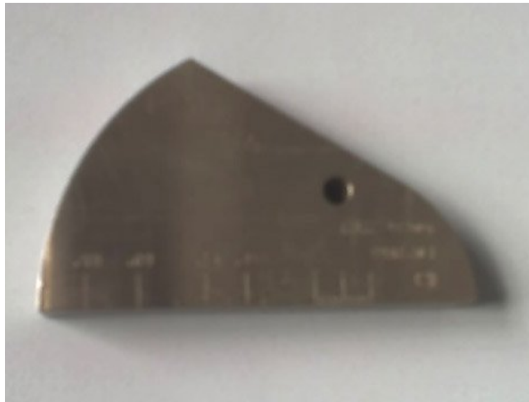
Slika 9. Referentni etalon V2
