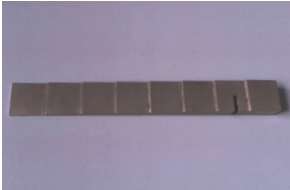
Slika 11. Referentni etalon VW
