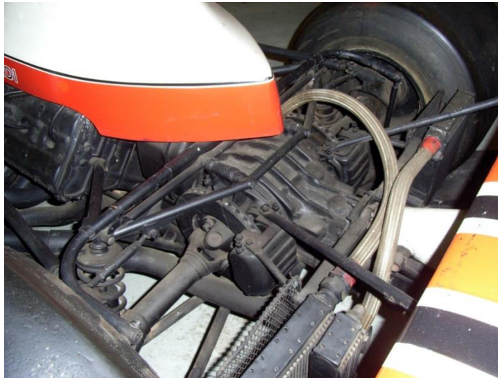
Slika 7. Kočnice unutar bolida na Mclarenu M23 [6]
