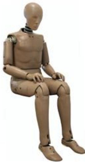
Slika 6. Hybrid III "crash" test lutka [13]
