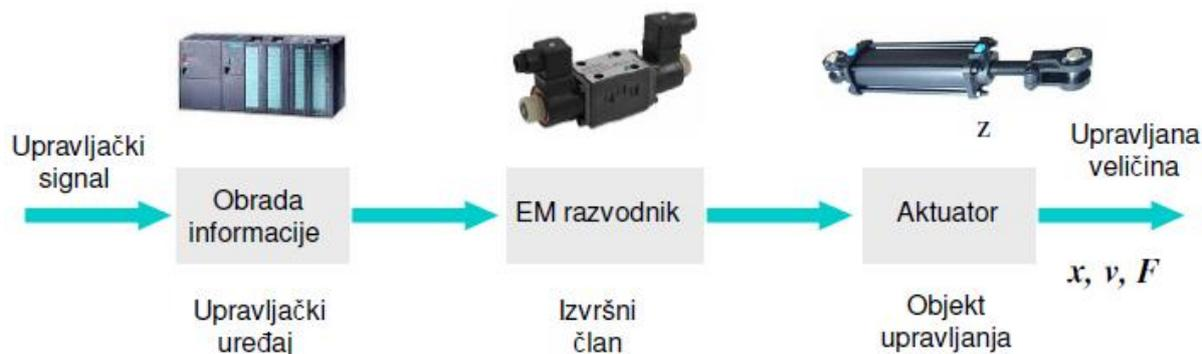
**Slika 3. Upravljanje klasičnom hidraulikom korištenjem elektromagnetskog razvodnika [3]**
