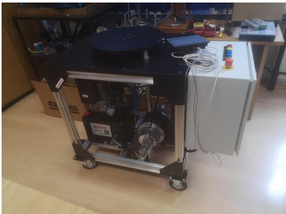
Slika 16. Fotografija postava direktno pogonjenog hidrauličkog sustava
