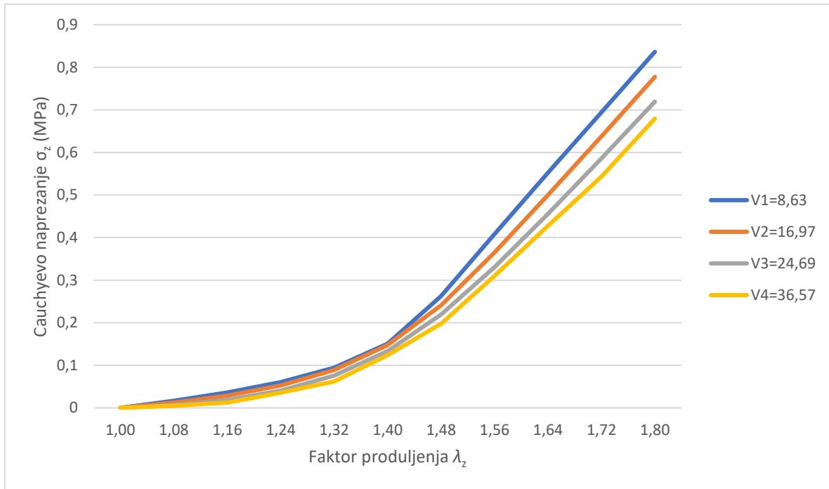
Slika 25. Ovisnost maksimalnog Cauchyevog naprezanja zavojnice koncepta 1 pri krutosti  $C_1=0,3494 \text{ MPa}$  o faktoru produljenja za različite volumne omjere matrice i zavojnice  $V_i$
