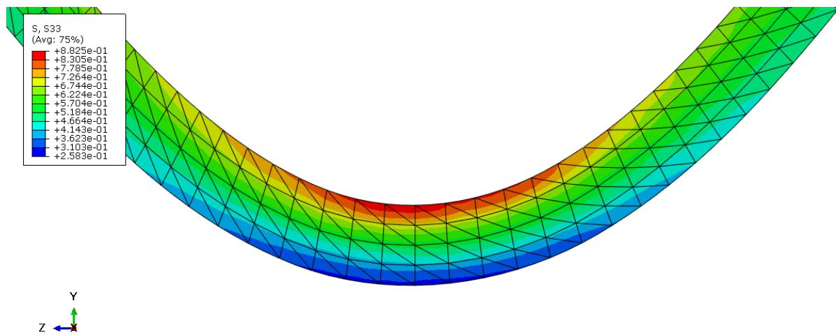
Slika 23. Raspodjela Cauchyevog naprezanja na karakterističnom presjeku zavojnice
