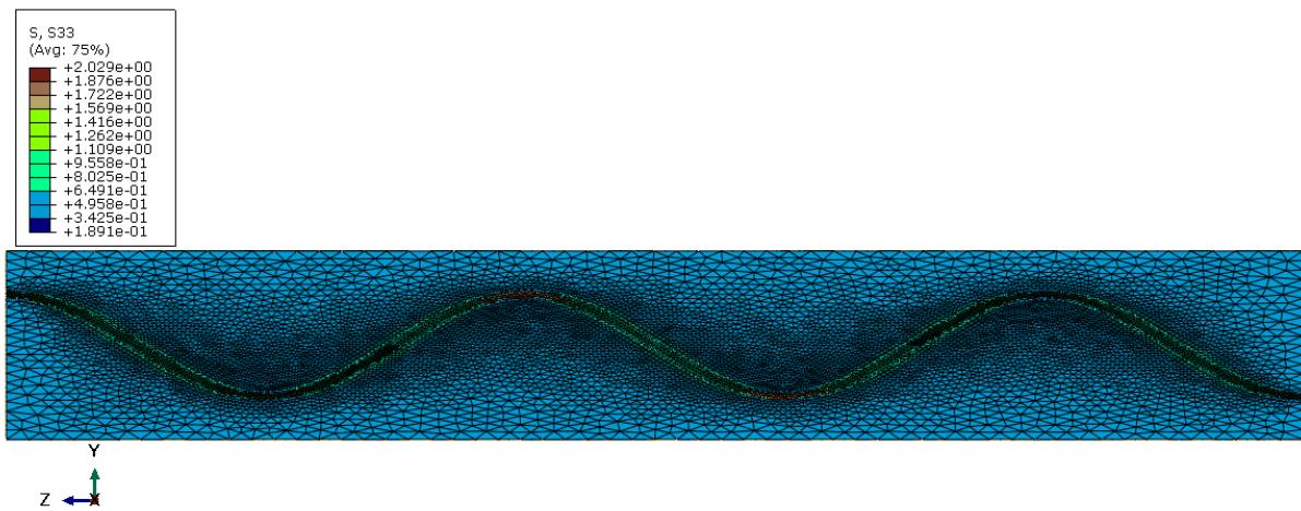
Slika 34. Raspodjela Cauchyevog naprezanja na deformiranom modelu koncepta 3
