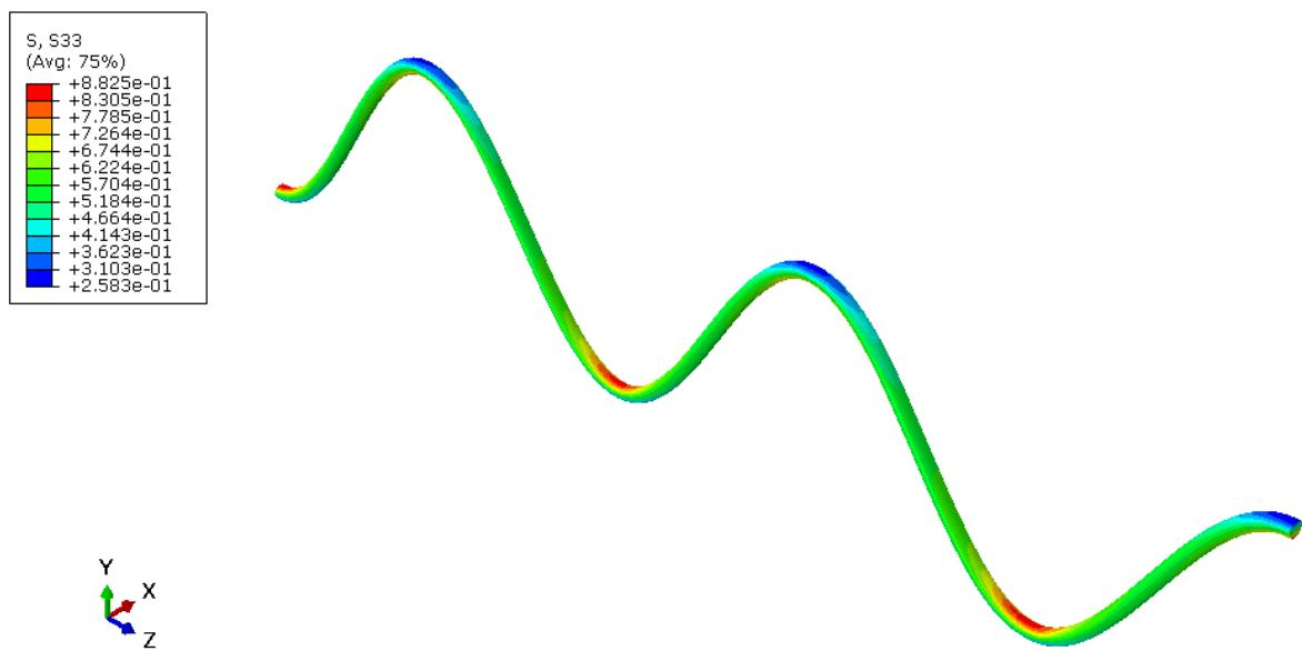
Slika 22. Raspodjela Cauchyevog naprezanja na polovini zavojnice koncepta 1
