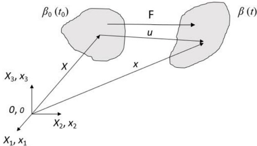
Slika 5. Prikaz tijela u referentnoj i trenutnoj konfiguraciji
