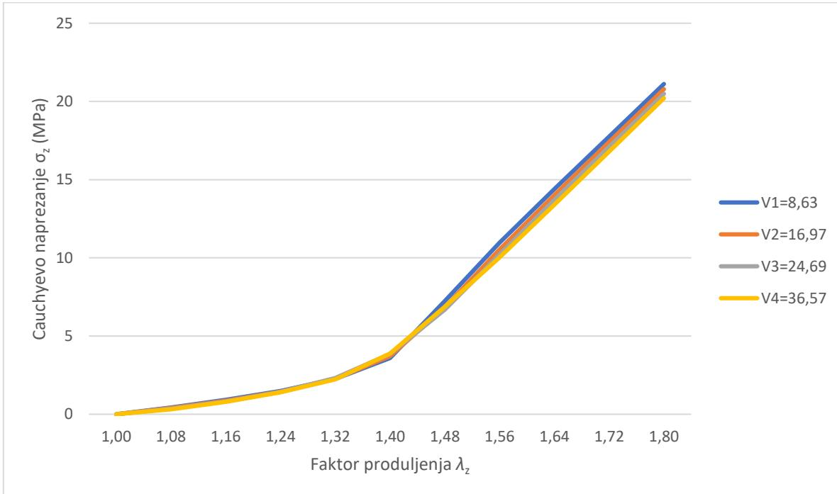
Slika 26. Ovisnost maksimalnog Cauchyevog naprezanja zavojnice koncepta 1 pri krutosti  $C_1=8 \text{ MPa}$  o faktoru produljenja
