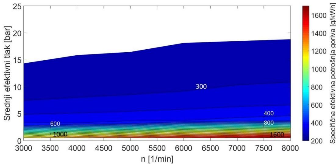
**Slika 26. Specifična efektivna potrošnja goriva konvencionalnog motora**
