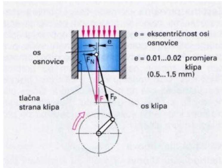
**Slika 1. Sile na klipu s ekscentričnom osovinicom [2]**
