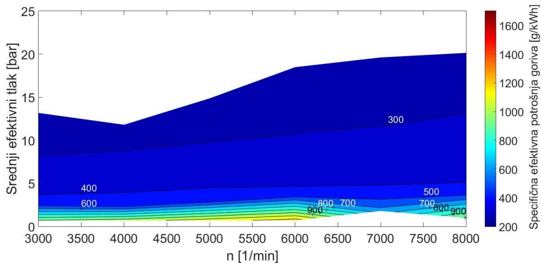
Slika 25. Specifična efektivna potrošnja goriva u inovativnog motora
