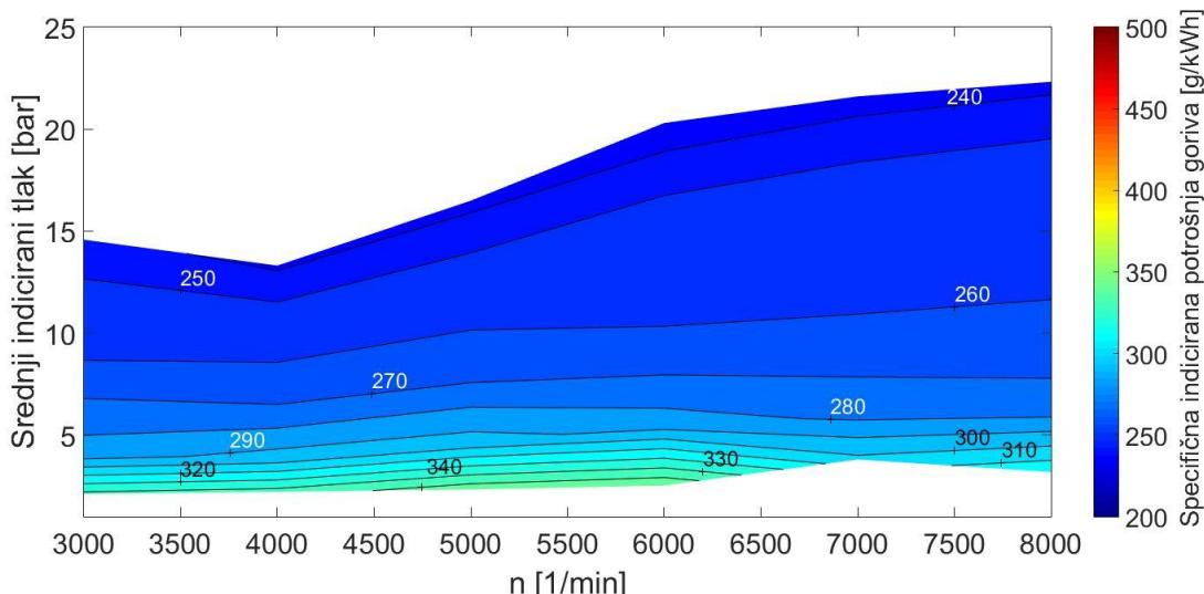
**Slika 23. Specifična indicirana potrošnja goriva inovativnog motora**
