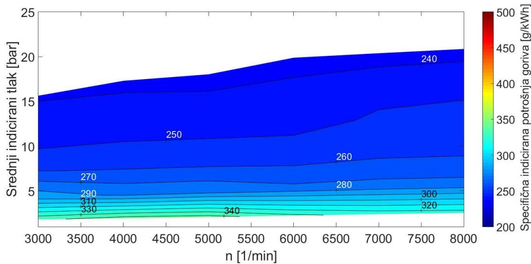
Slika 24. Specifična indicirana potrošnja goriva konvencionalnog motora
