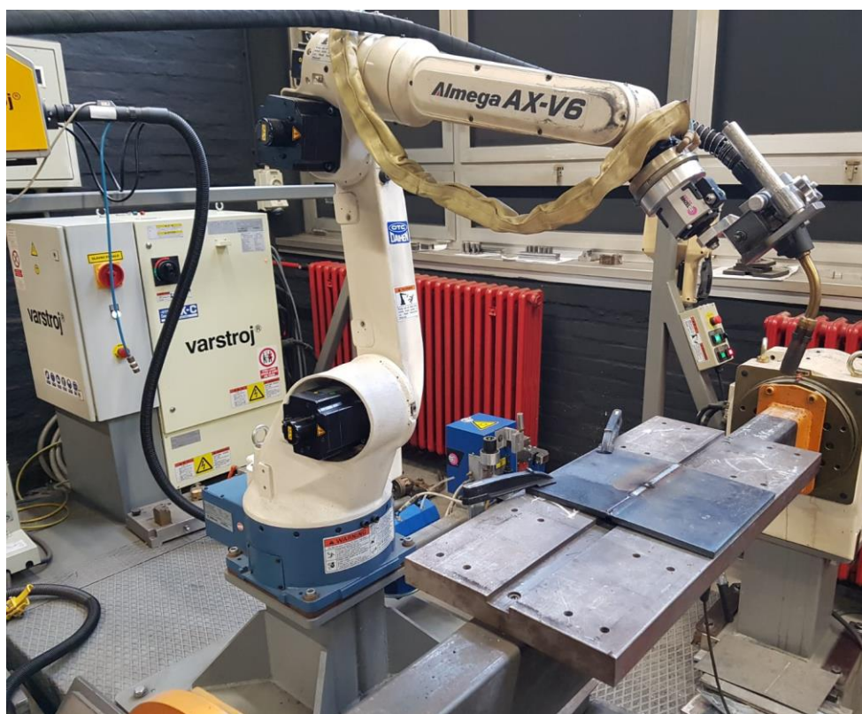
Slika 33. Robotska ruka korištena prilikom zavarivanja [24]
