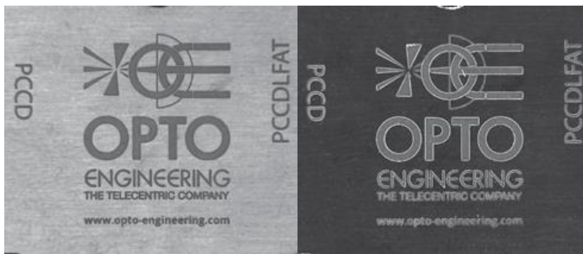
Slika 26 Razlika između osvjetljenja primjenom svijetlog i tamnog polja
