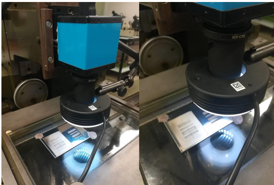
Slika 23 Optičko mjerenje uz uporabu frontalne rasvjete
