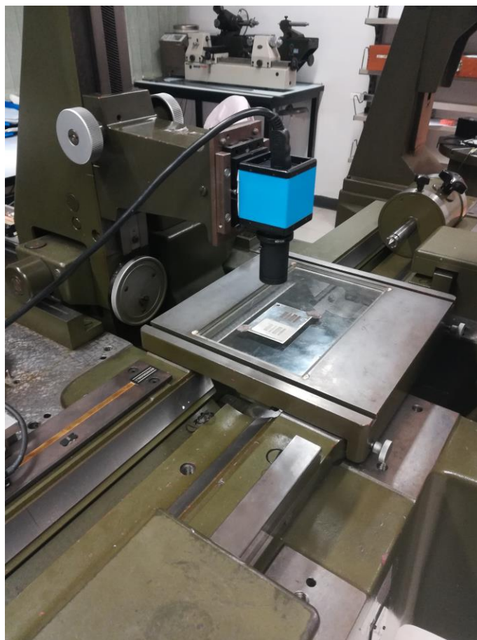
Slika 1 Carl Zeiss Jena alatni mikroskop
