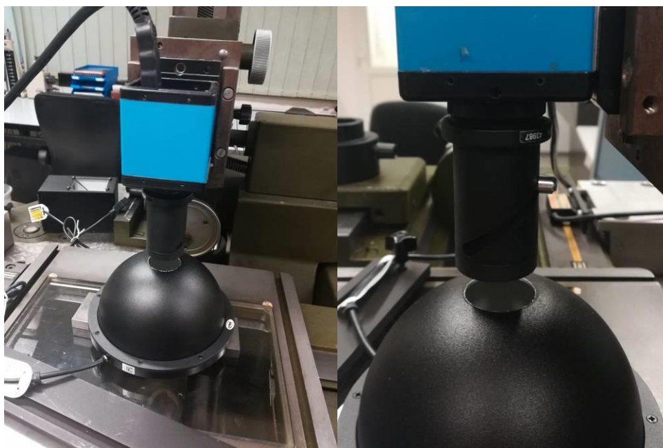
Slika 24 Optičko mjerenje uz uporabu kupolaste rasvjete
