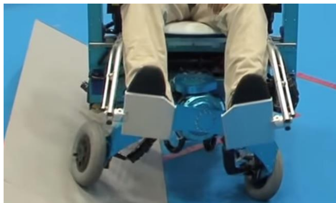
Slika 9. Stabilizacija određene strane vozila
