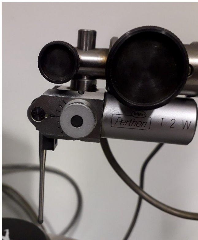
Slika 8. Induktivno ticalo za mjerenje odstupanja od kružnosti
