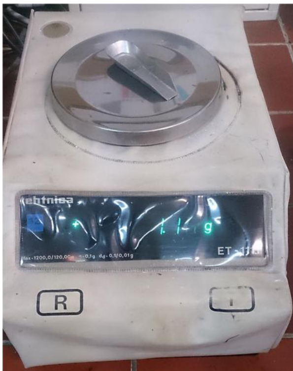
Slika 21. Vaganje disperzanta Dolapix CE-64
