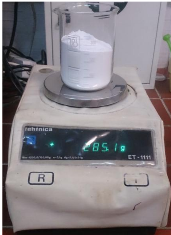
Slika 18. Vaganje mikro \text{Al}_2\text{O}_3 praša
