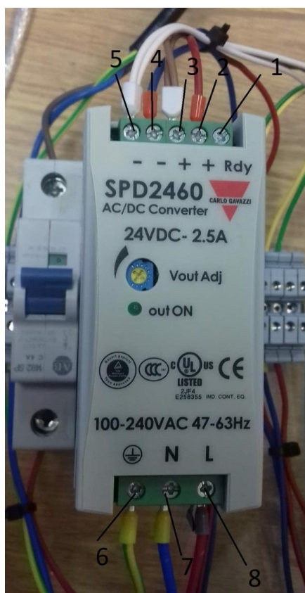
Slika 13 - Ispravljač SPD 24 60 1 B tvtkte Carlo Gavazzi s prikazanim pinovima
