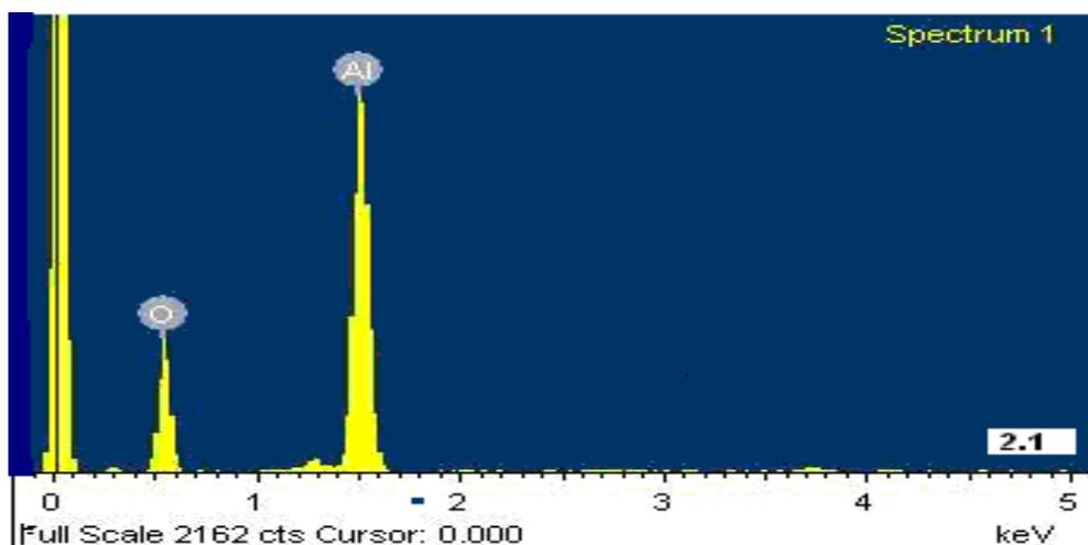
Slika 35. Linijska mikroanaliza elemenata oksidnog sloja  $\text{Al}_2\text{O}_3$  uzorka 2.1
