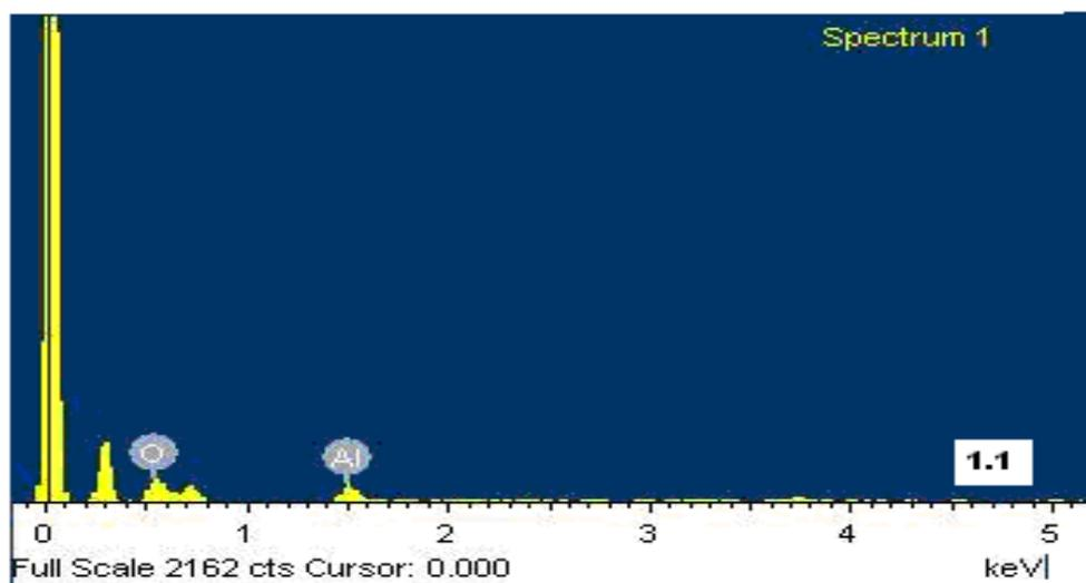
Slika 31. Linijska mikroanaliza elemenata oksidnog sloja  $\text{Al}_2\text{O}_3$  uzorka 1.1
