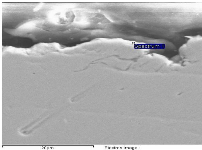
Slika 32. Slika oksidnog sloja  $\text{Al}_2\text{O}_3$  uzorka 1.2
