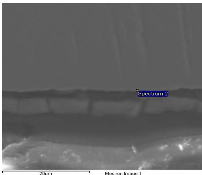
Slika 40. Slika oksidnog sloja  $\text{Al}_2\text{O}_3$  na uzorku 3.2
