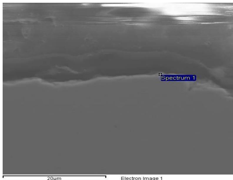
Slika 30. Slika oksidnog sloja  $\text{Al}_2\text{O}_3$  uzorka 1.1
