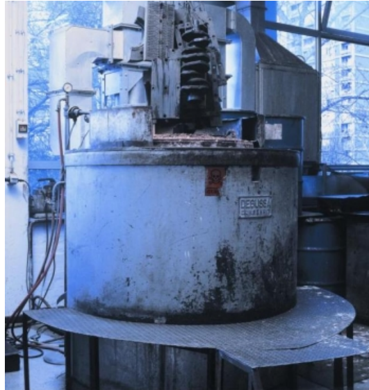
Slika 16. Nitriranje i nitrokarburiranje - radilica motora u solnoj kupci postupkom TENIFER [18]
