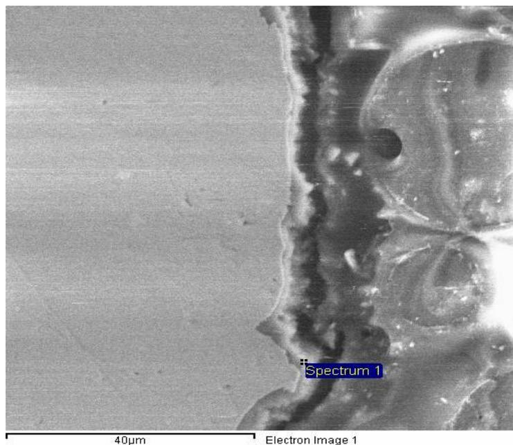
Slika 34. Slika oksidnog sloja  $\text{Al}_2\text{O}_3$  uzorka 2.1
