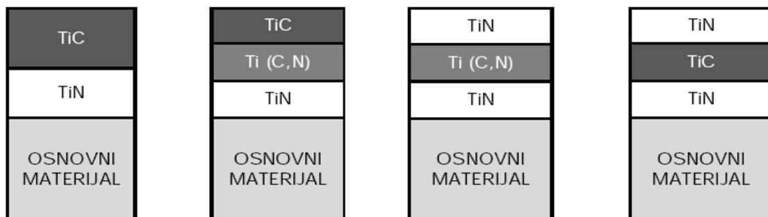
Slika 17. Primjer prevlaka nastalih toplinskim neparivanjem [13]
