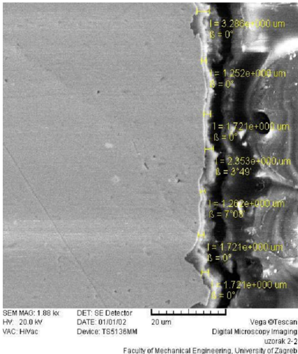
Slika 39. Slika uzorka 2.2 s prosječnom debljinom oksidnog sloja  $\text{Al}_2\text{O}_3$  ( $d_{\text{sr}} = 1.7 \mu\text{m}$ )
