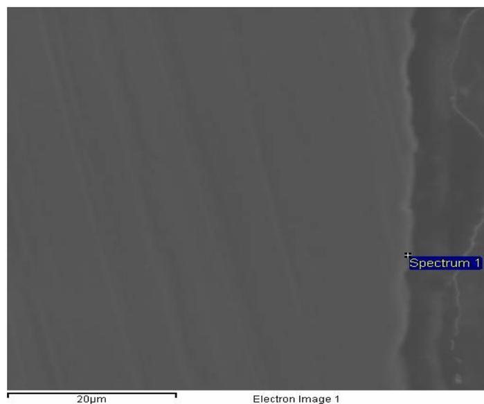
Slika 42. Slika oksidnog sloja  $\text{Al}_2\text{O}_3$  na uzorku 3.3
