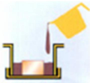
Slika 19. Shematski prikaz tehnike hladnog zalijevanja
