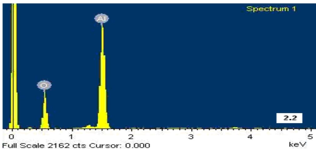
Slika 38. Linijska mikroanaliza elemenata oksidnog sloja  $\text{Al}_2\text{O}_3$  uzorka 2.2
