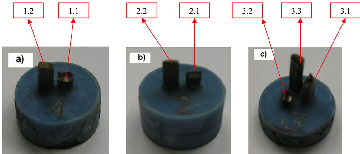
Slika 22. Pripremljeni ispitni uzorci od čelika KANTHAL - A1 za analizu mikrostrukture:
