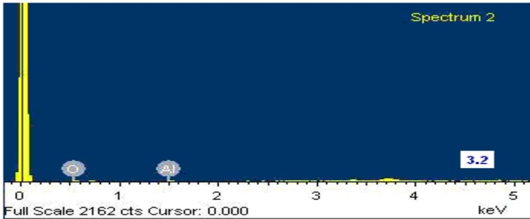
Slika 41. Linijska mikroanaliza elemenata oksidnog sloja  $\text{Al}_2\text{O}_3$  uzorka 3.2
