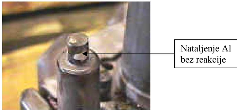
Slika 4. Nataljenje Al bez reakcije na alatu za tlačni lijev aluminijski [5]
