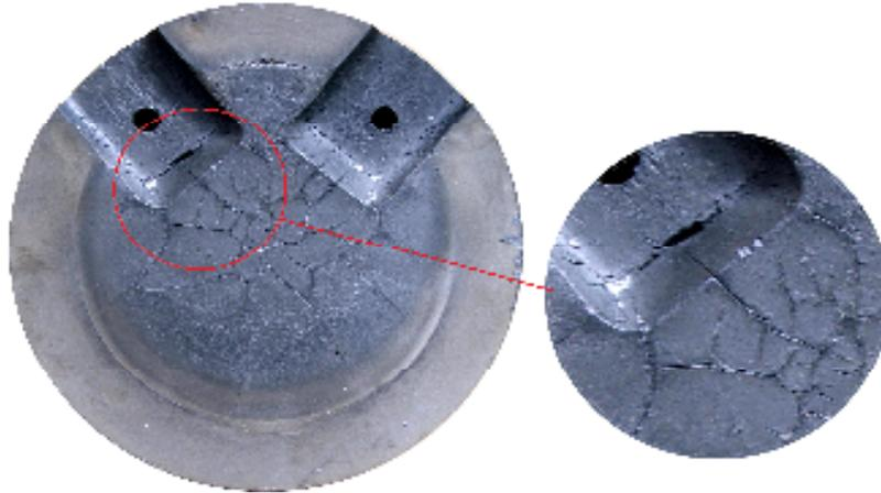
Slika 5. Toplinski umor površine na čepu udarne ploče [6]
