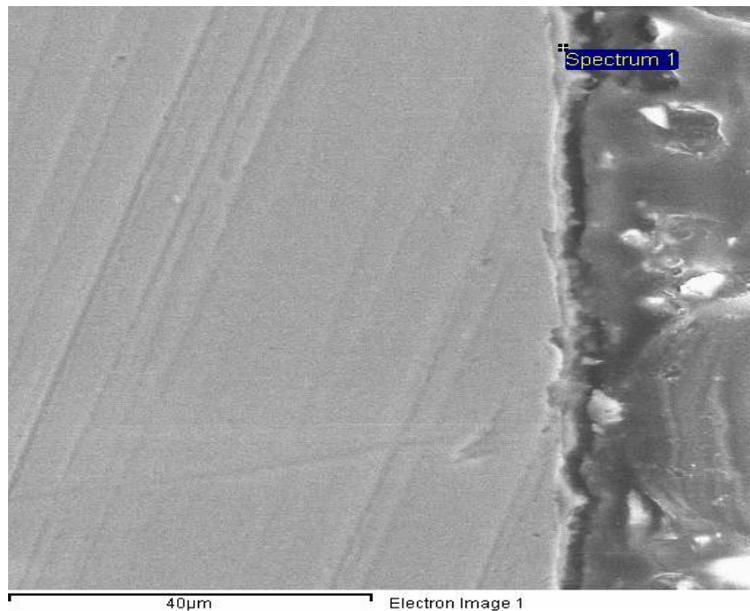
Slika 37. Slika oksidnog sloja  $\text{Al}_2\text{O}_3$  na uzorku 2.2
