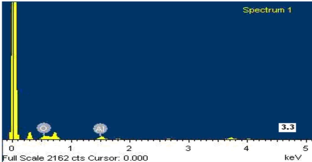
Slika 43. Linijska mikroanaliza elemenata oksidnog sloja  $\text{Al}_2\text{O}_3$  uzorka 3.3
