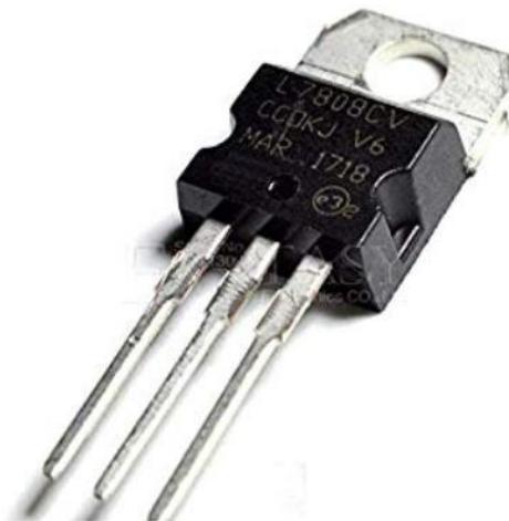
Slika 15. Stabilizator napona 7808
