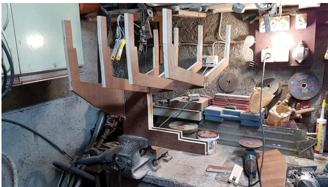
Slika 6. Rebra postavljena na kobilicu broda
