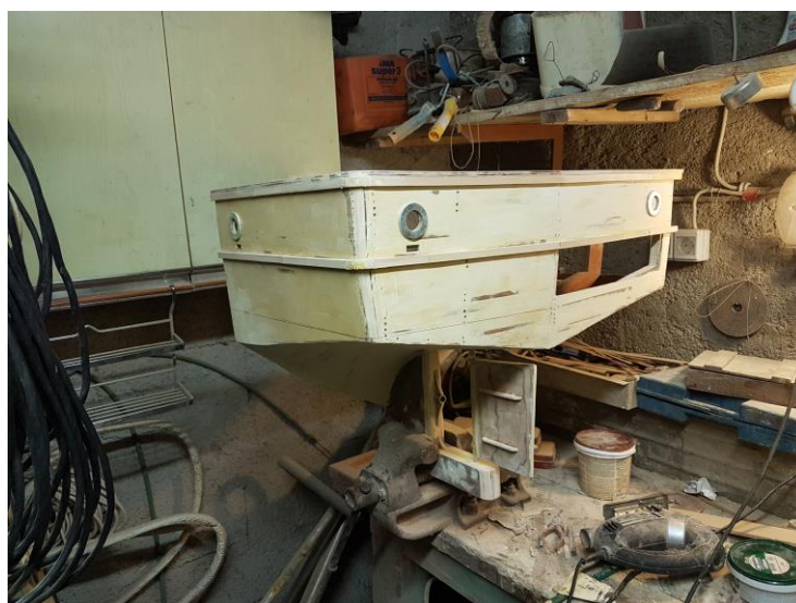
Slika 12. Konstrukcija krme broda
