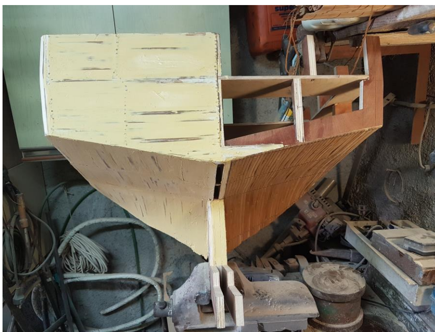
Slika 9. Nanošenje akrilnog kita
