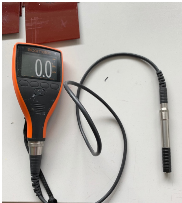
Slika 7.2.2. Uređaj za mjerenje debljine suhog filma „ELCOMETER 456“
