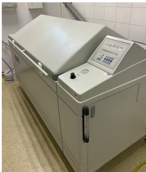
Slika 7.5.1. Slana komora, HELIOS Slovenija
