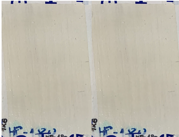
Slika 7.8.2.1. Uzorak prije i nakon izlaganja slanoj komori
