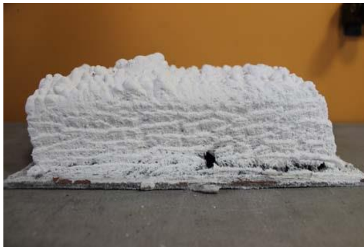
Slika 5.4.2. Ekspanirajući premaz nakon reakcije [11]
