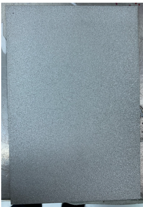
Slika 7.1.1. Ispitna pločica dimenzija 100 mm x 150 mm x 5 mm
