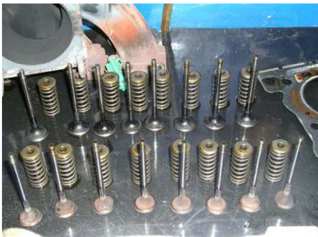
Slika 5.4 – Ventili motora testnog vozila
