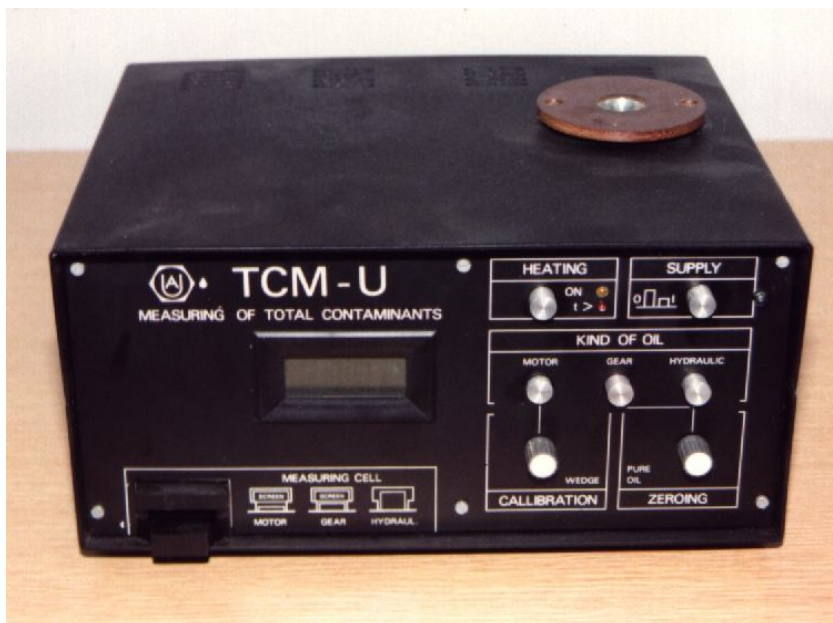
Slika 5.7 - Uređaj za mjerenje zagađenja ulja TCM – U
