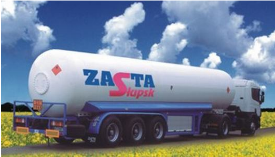
Slika 2.5 - Kamionska cisterna za transport UNP-a [7]
