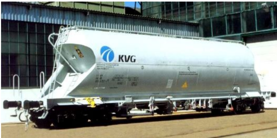
Slika 2.6 - Željeznička cisterna za transport UNP-a [8]
