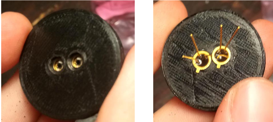
Slika 29 Najmanji mogući razmak aktivnih fotodioda u TO-18 kućištu
