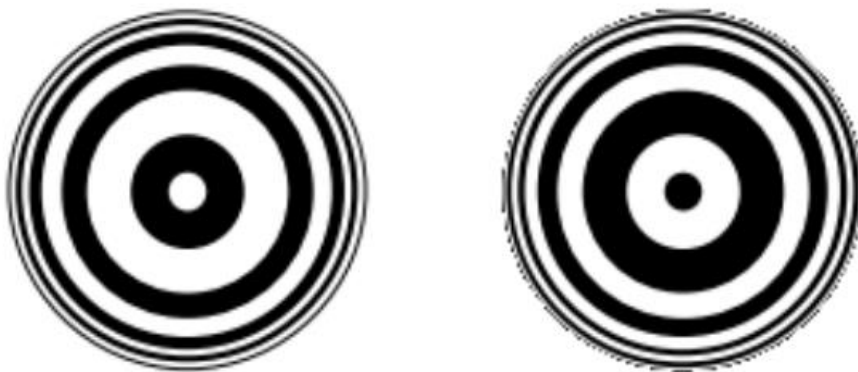
Slika 7 Primjer potpunog prijelaza iz konstruktivne u destruktivnu interferenciju
