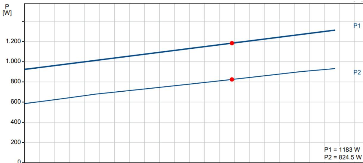
Slika 3. Ulazna i nazivna električna snaga SEG pumpe
