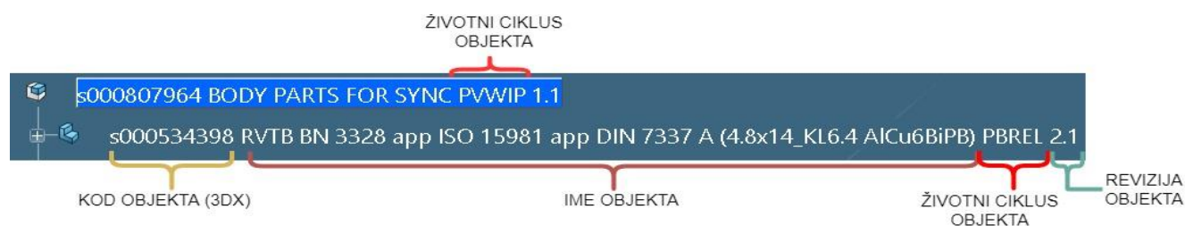
- Slika 43. Struktura naziva objekta unutar 3DExperience sustava
