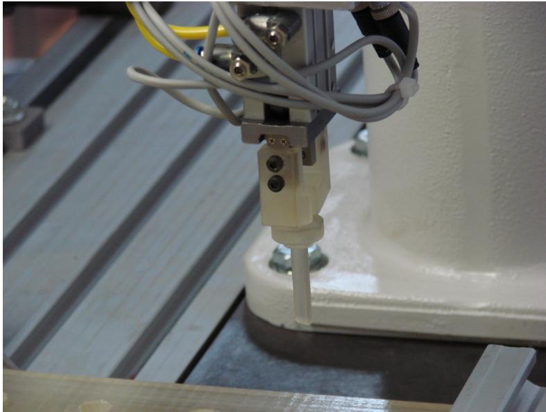
Slika 6.17. Prijenos osovinice u prihvatu hvataljke robota.
