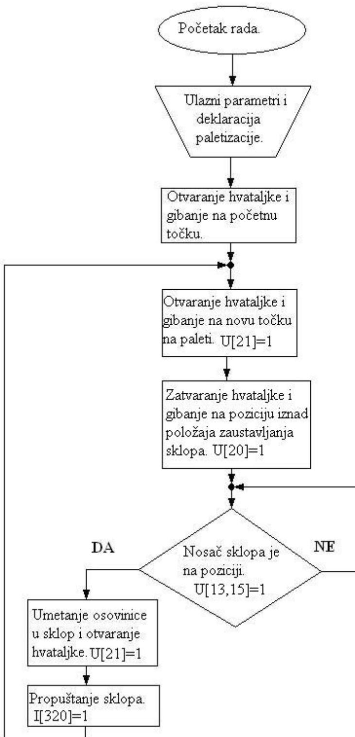
Slika 5.13. Blok dijagram rješenja zadatka za programiranje paletizacije SCARA robota.
