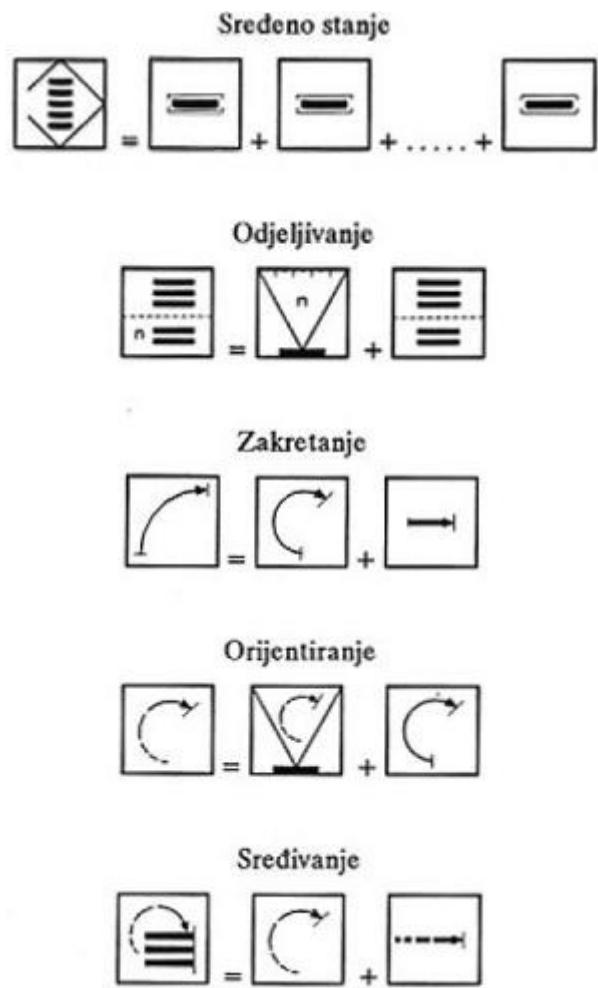
Slika 2.3.Prikaz najčešće korištenih kombinacija postupaka u automatskoj montaži<sup>[3]</sup>.
