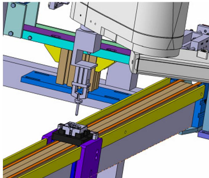
Slika 6.10. Robot na poziciji za sklapanje osovinice.
