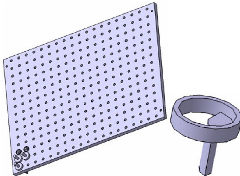
Slika 5.5. Paleta izvedena sa ulošcima za orientiranje osovinica i prikaz pojedinog uloška.
