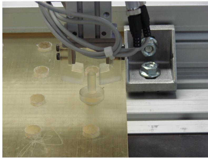
Slika 6.15. Robot u poziciji za prihvati osovinice na paleti.
