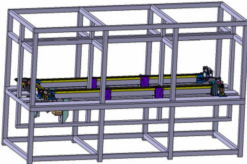
Slika 4.7. CAD model sustava sa automatskom transportnom trakom.
