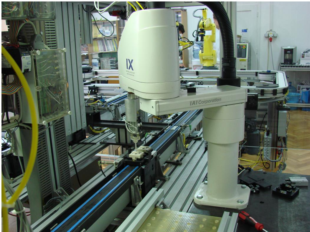
Slika 6.19 Umetanje krivuljne osovinice pomoću SCARA robota.
