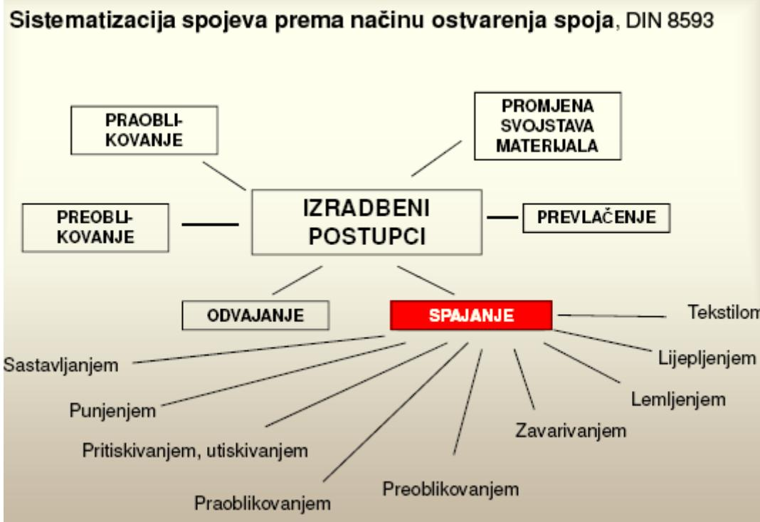
Slika 2.1. Podjela spojeva prema načinu ostvarenja za standard DIN 8593<sup>[3]</sup>.
