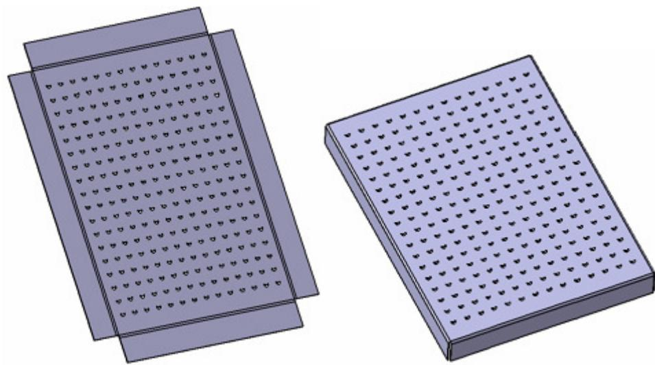
Slika 5.3. Paleta za osovinicu prije savijanja i paleta izrađena savijanjem lima.
