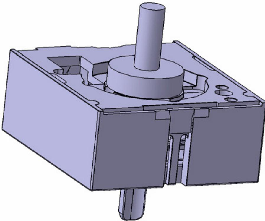
Slika 5.12. Konačni sklop kućišta, poklopca i osovine termoregulatora.
