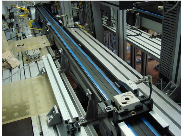
Slika 6.13. Nosač proizvoda na poziciji trake za sklapanje.
