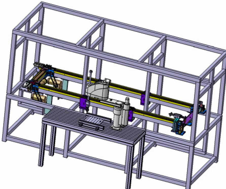
Slika 6.1. CAD model izgleda transportnog sustava sa integriranim robotskom stanicom.
