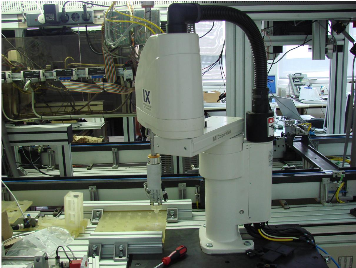
Slika 6.16. SCARA robot pri izvlačenju krivuljne osovinice.
