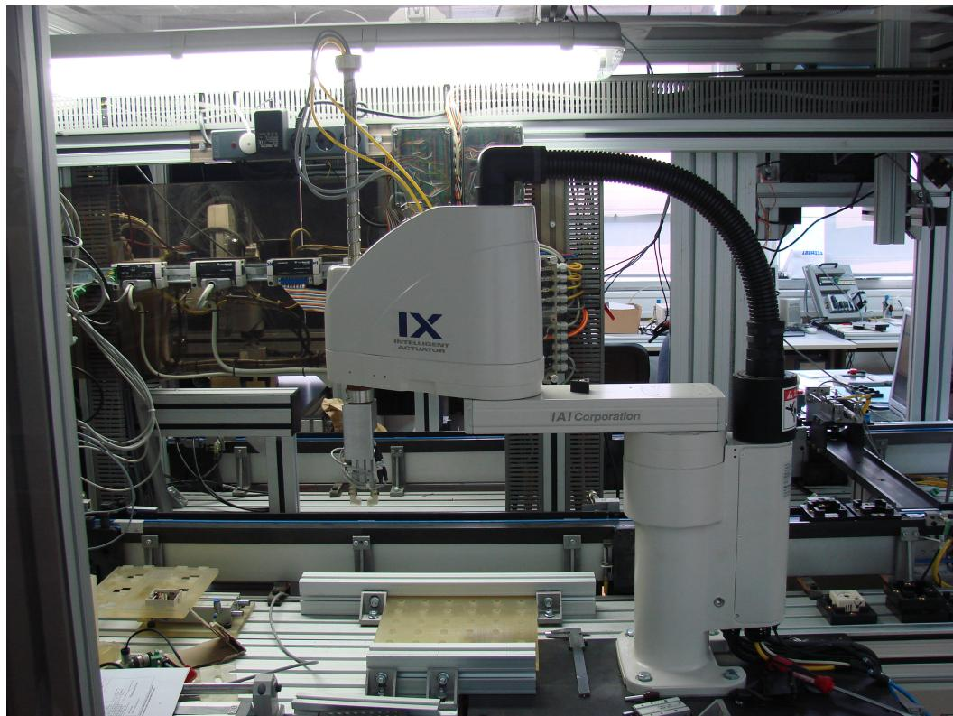
Slika 6.7. Programirani SCARA robot za rješenje zadatka u realnom okruženju laboratorijski.
