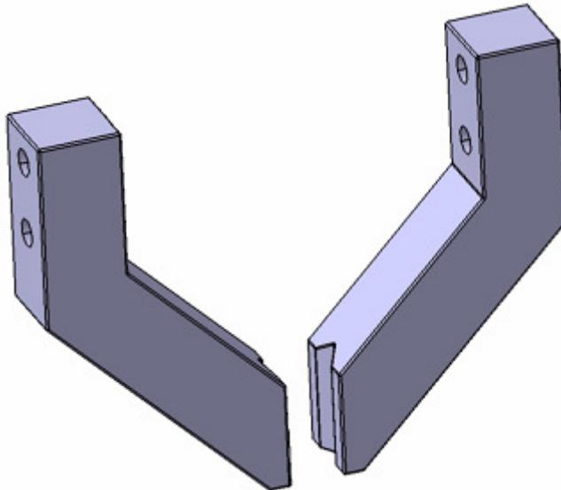
Slika 5.8. Model konstruiranih nastavaka hvataljke za prihvatanje osovinice pomoću SCARA robota.
