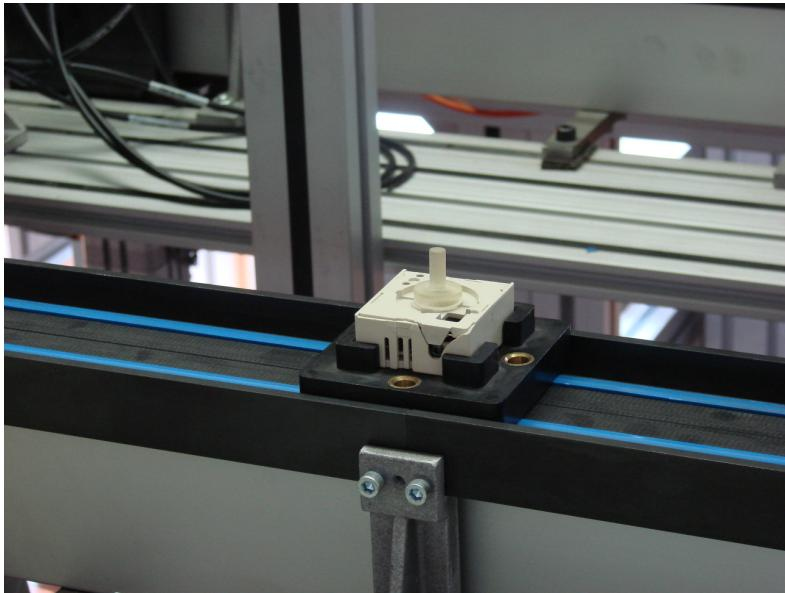
Slika 6.21. Proizvod sa montažnoj traci nakon sklapanja.
