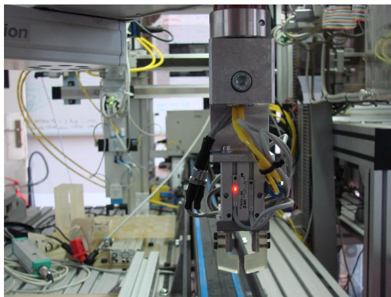
Slika 6.3.Hvataljka i nastavci za prihvatanje SCARA robota.
