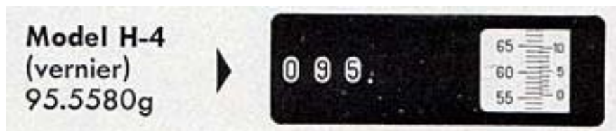
Slika 27. Princip očitavanja rezultata mjerenja [25]
