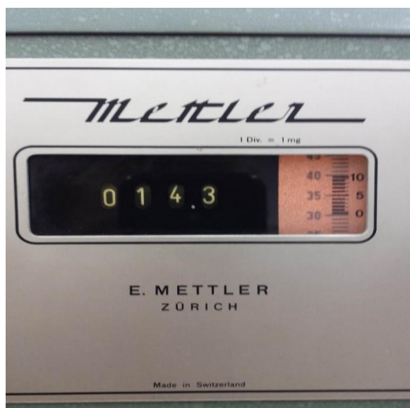
Slika 26. Prikaz očitavanja rezultata s analogne mehaničke vage
