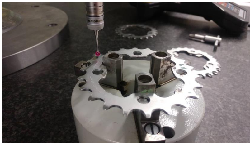
Slika 33. Mjerenje odstupanja od ravnosti lančanika
