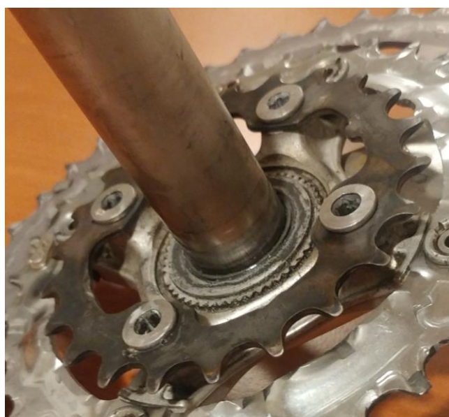
Slika 21. Lančanic nitriran plazma potpomognutim proces fotografiran nakon ugradnje na pogonski sklop prije početka eksploatacijskog trošenja
