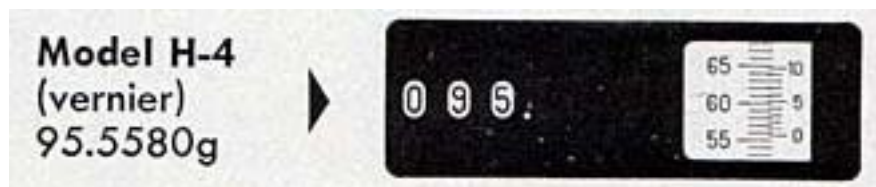
Slika 27. Princip očitavanja rezultata mjerenja [25]
