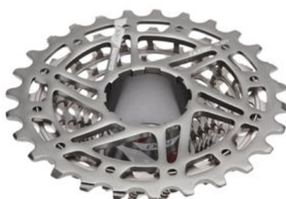
Slika 9. SRAM kazeta iz jednog komada čelika[11]
