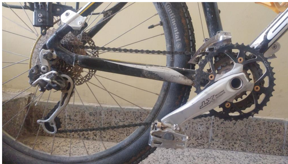
Slika 23. Fotografija 3 x 9 prijenosa cross-country brdskog bicikla
