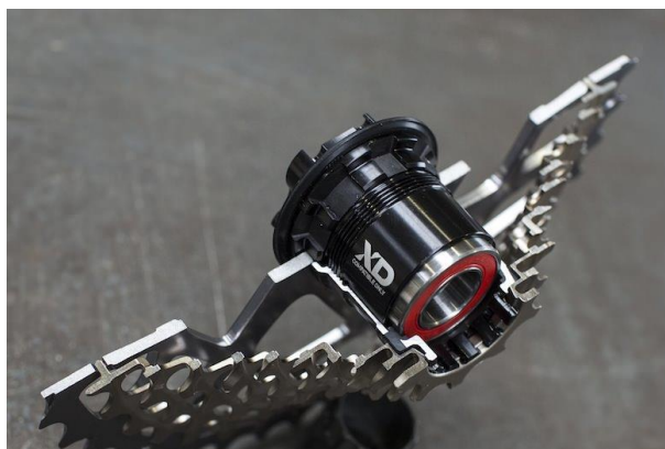
Slika 10. SRAM XD nosač kazete i SRAM kazeta u presjeku[12]
