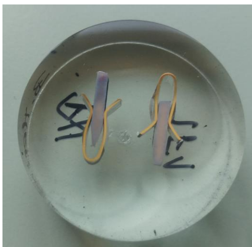
Slika 37. Prikaz metalografskih uzoraka
