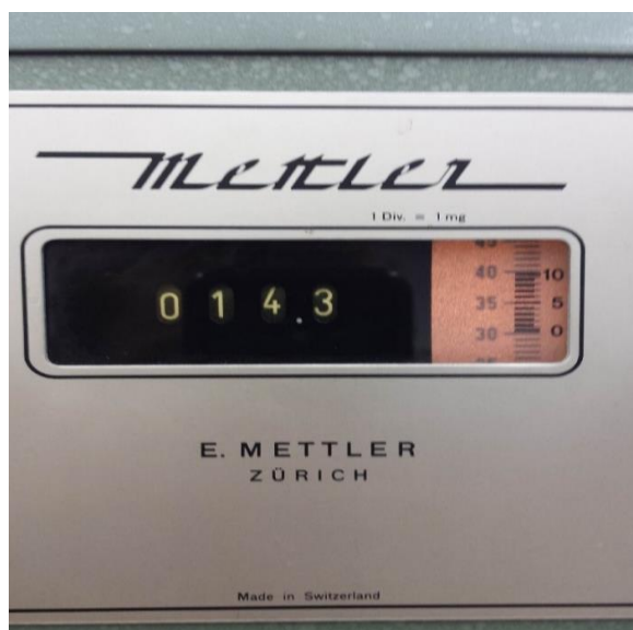
Slika 26. Prikaz očitavanja rezultata s analogne mehaničke vage
