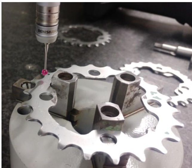
Slika 20. Lančanic u neobrađenom stanju fotografiran za vrijeme mjerenja ravnosti na koordinatnom mjernom uređaju
