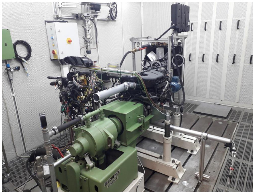
Slika 55. Ispitni motor PSA DV6 priključen na hidrauličku kočnicu
