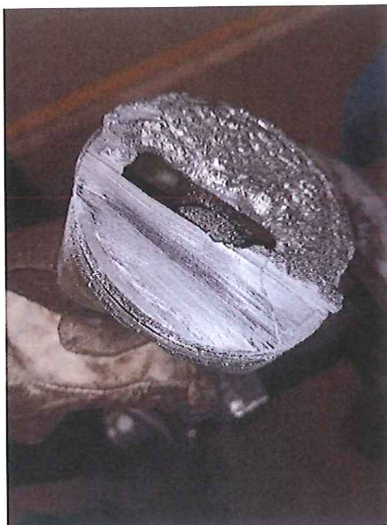
Slika 37. Mjesto rezanja na klipu za analizu mikrostrukture
