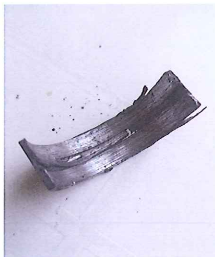
Slika 17. Istrošenost kliznog ležaja 1.4 TDI motora
