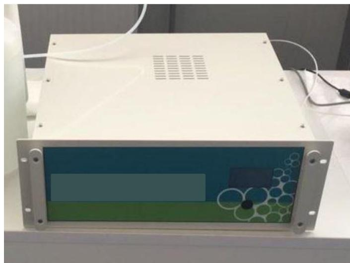
Slika 7. Komercijalni PEM elektrolizator sustava za proizvodnju vodika
