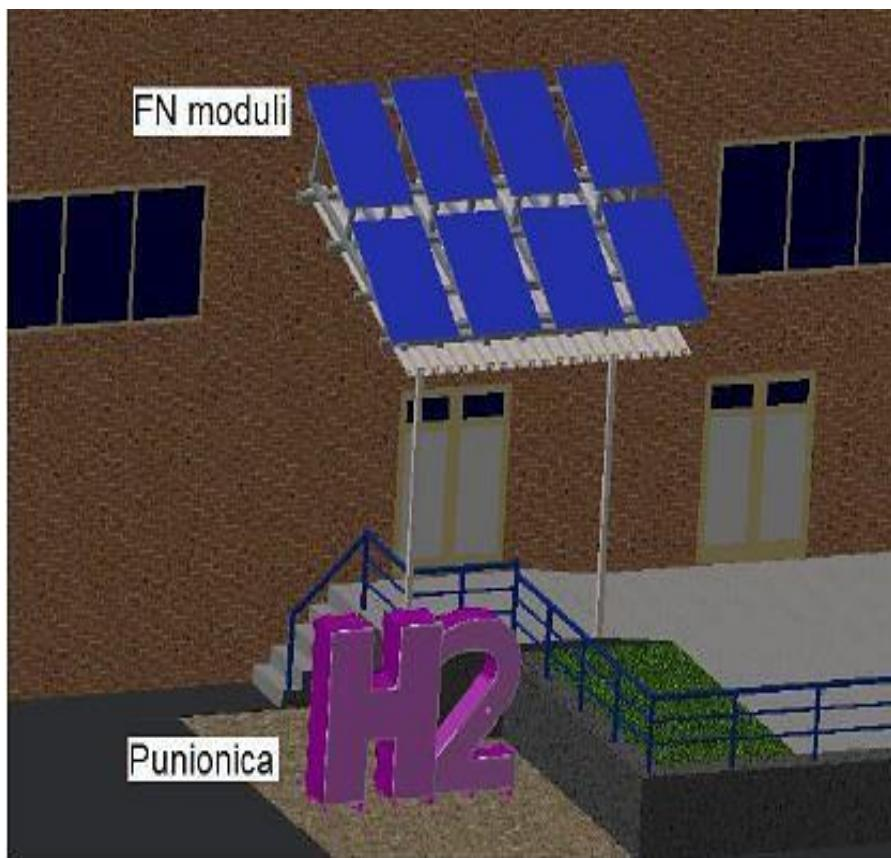
Slika 2. Idejni koncept autonomne sunčane punionice vodika [14]
