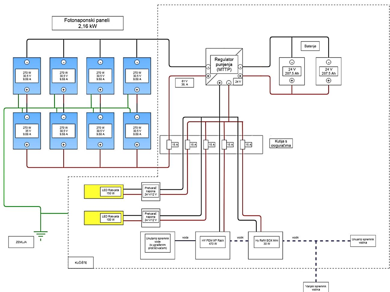
Slika 3. Shema sustava punionice vodika [14]
