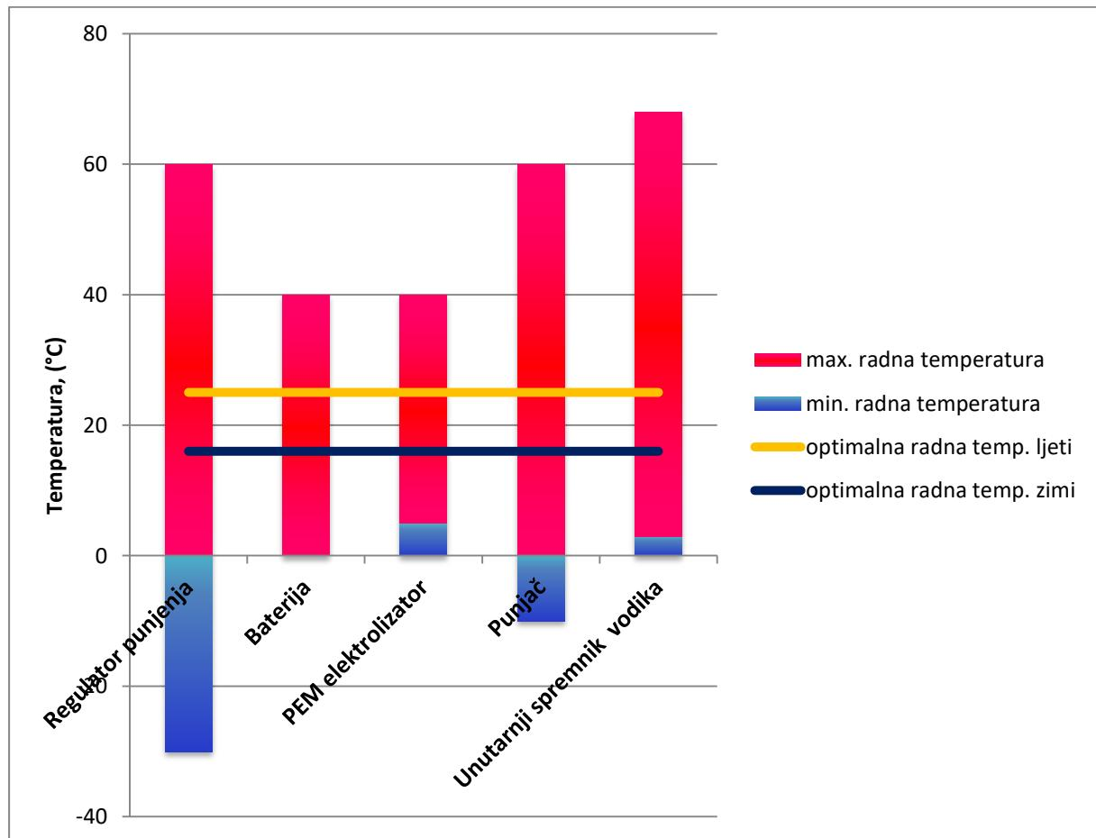
**Slika 8. Optimalne radne temperature komponenata punionice vodika**
