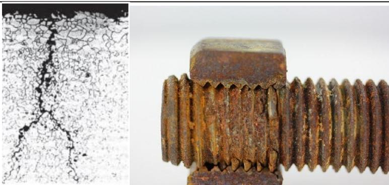
Slika 14: Napetosna korozija [13].
