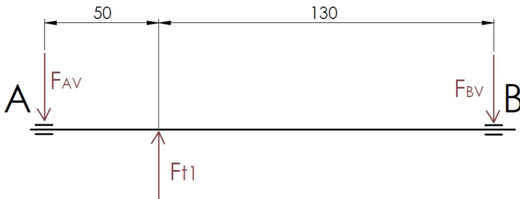
Slika 66: Opterećenja vratila 1 u vertikalnoj ravnini.
