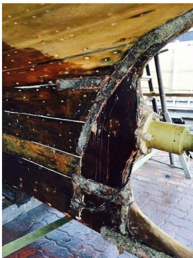
Slika 16: Utjecaj korozije na drvenu konstrukciju.
