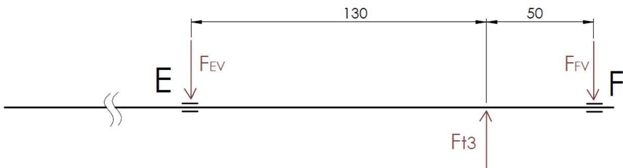
Slika 72: Opterećenja vratila 3 u vertikalnoj ravnini
