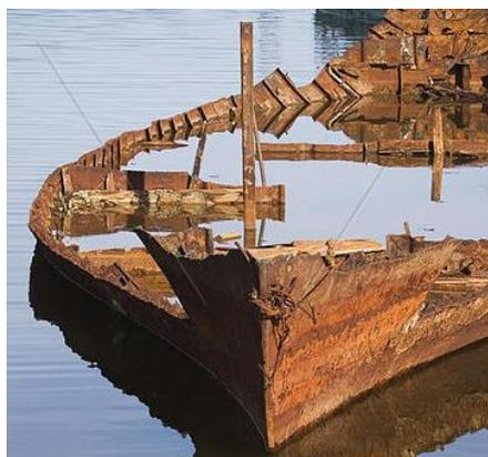
Slika 15: Plovilo uništeno korozijom.
