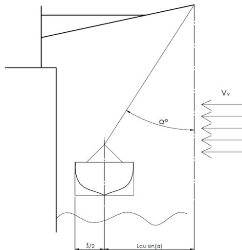
Slika 40: Minimalna duljina konzolne grane iznad površine mora.
