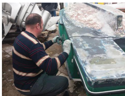
Slika 21: Brušenje gaza plovila na suhom vezu.
