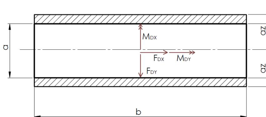
Slika 99: Poprečni presjek zavora sa pripadnim opterećenjima.
