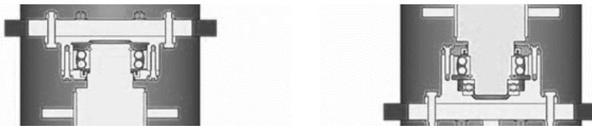
Slika 91: Ležajevi osovine.
