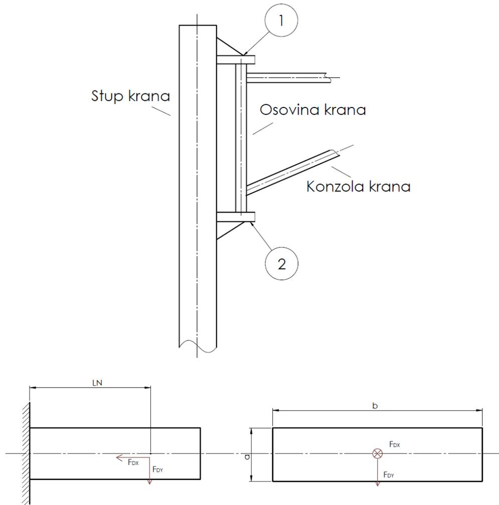
Slika 98: Pozicija, opterećenje i dimenzije nosača 2.
