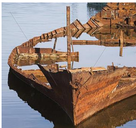
Slika 15: Plovilo uništeno korozijom.
