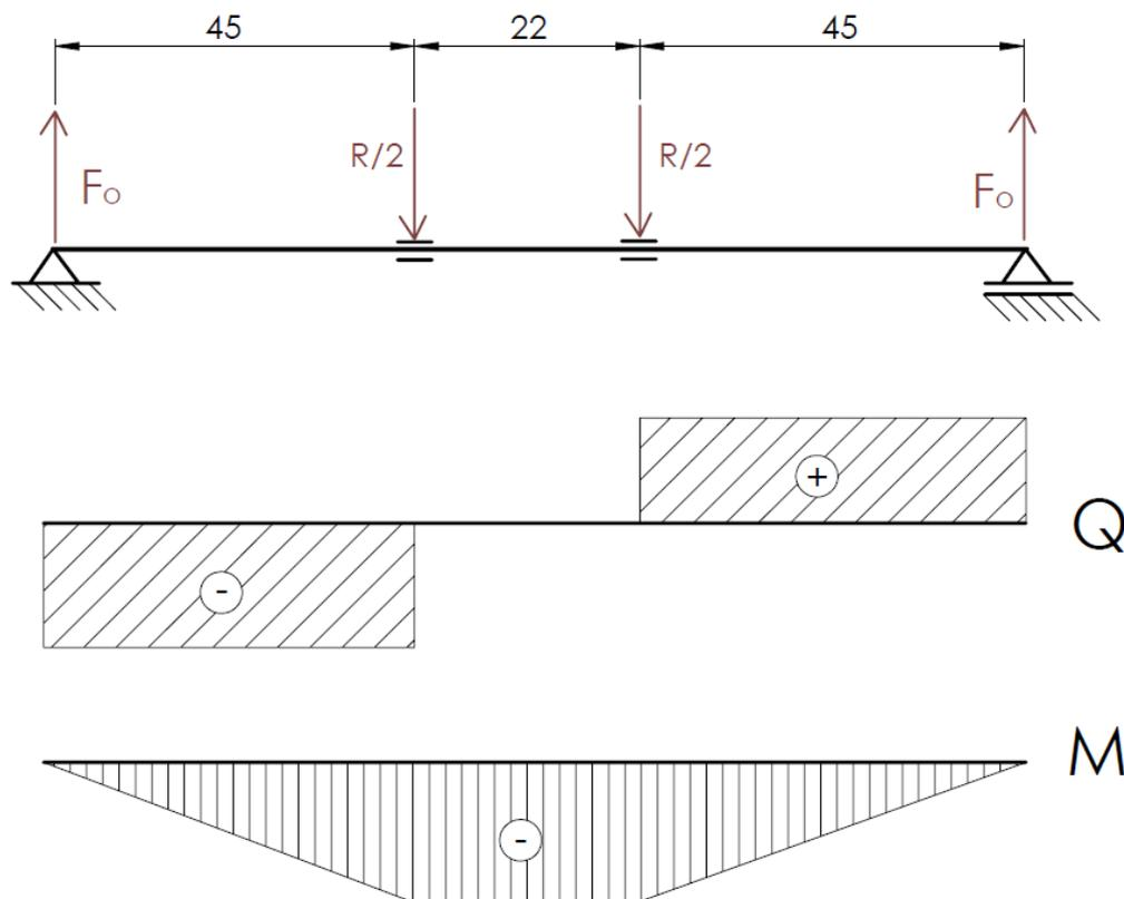
Slika 58: Unutarnja opterećenja osovine užnice.
