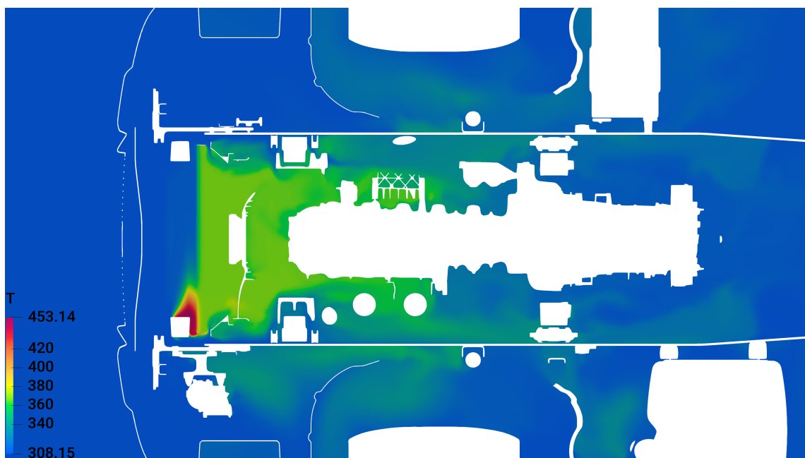
Slika 17: Ford Otosan kamion, rezultati topline, horizontalni presjek: temp. zraka.
