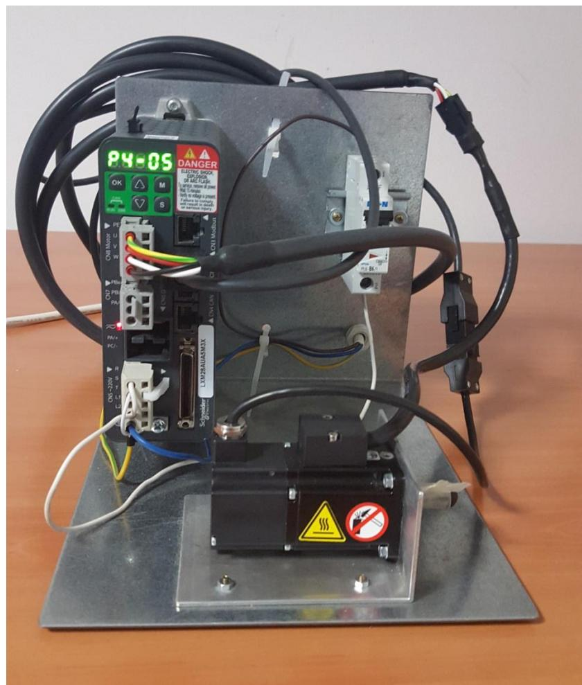
Slika 6. Fotografija eksperimentalnog postava servomotora s pretvaračem
