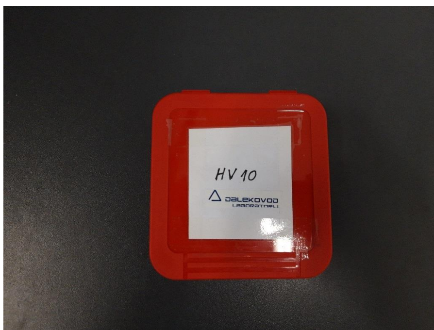
Slika 16 Certificirani referentni etalon za HV10
