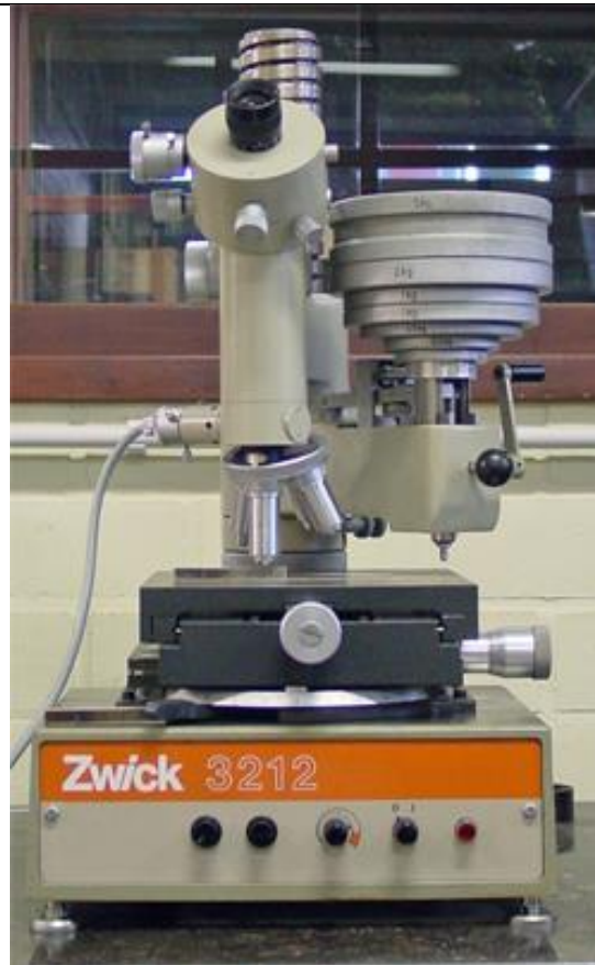
Slika 20 Primjer korištenog tvrdomjera kod laboratorija 2
