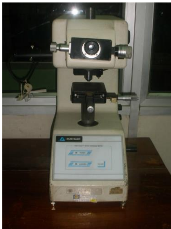
Slika 18 Primjer korištenog tvrdomjera u laboratoriju 1
