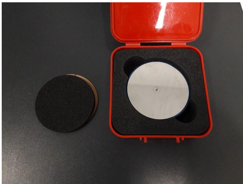
Slika 15 Certificirani referentni etalon za HV10
