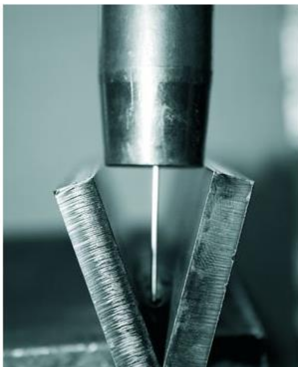
Slika 42. Izvođenje zavarivanja u uskome žlijebu s većom duljinom slobodnoga kraja žice [55]
