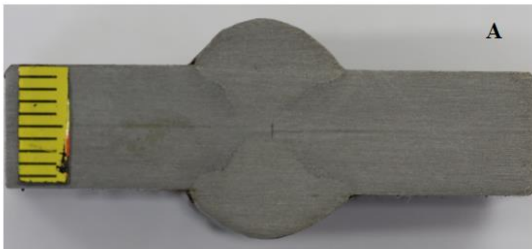
Slika 77. Makroizbrusak uzorka A
