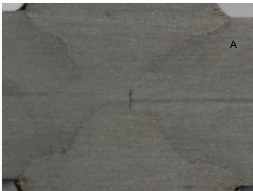
Slika 80. Nepotpuni provar uzorka A
