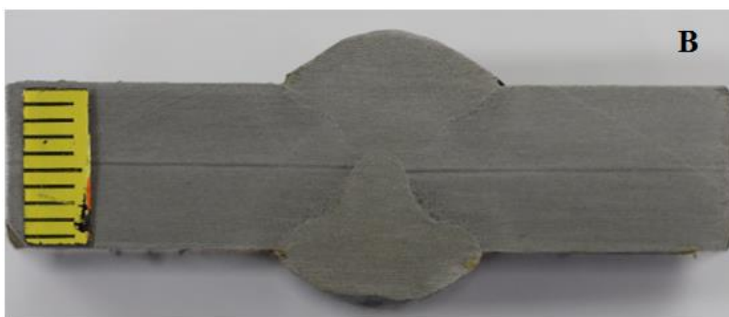
Slika 78. Makroizbrusak uzorka B
