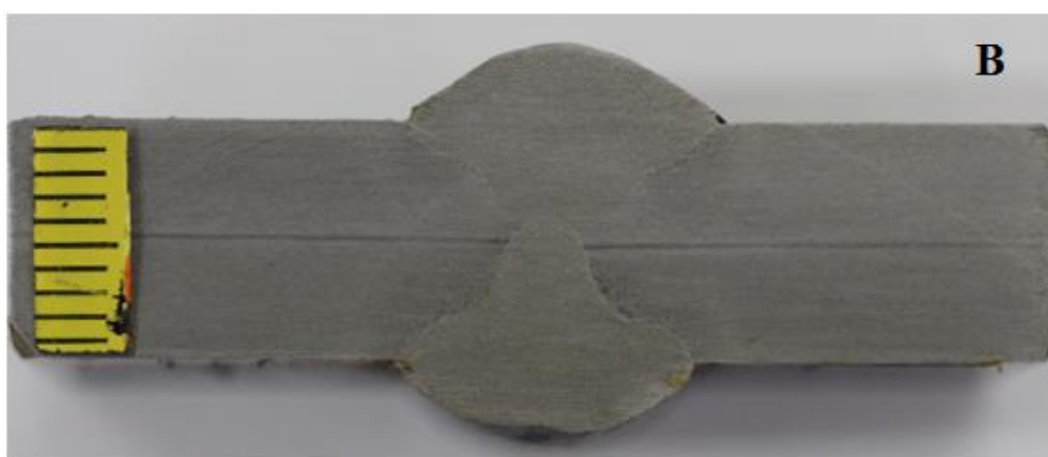
Slika 78. Makroizbrusak uzorka B
