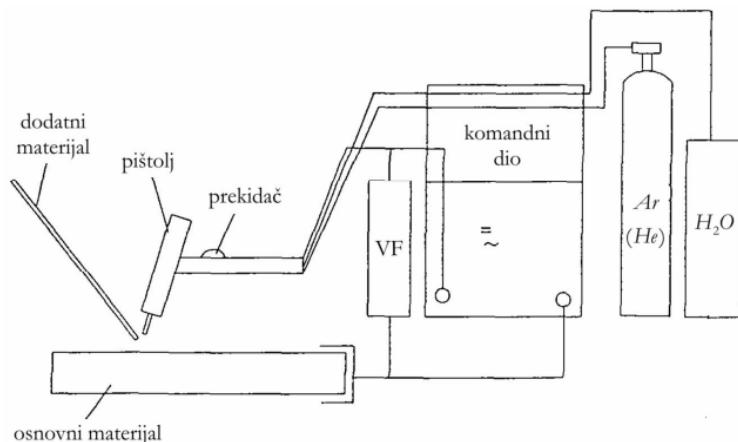
Slika 21. Shematski prikaz uređaja za TIG zavarivanje [19]
