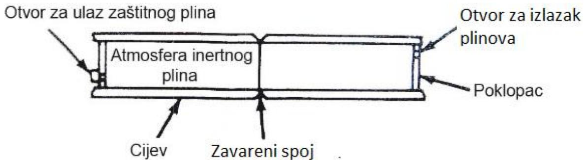
Slika 31. Zaštita korijena zavara kod spoja cijevi [32]
