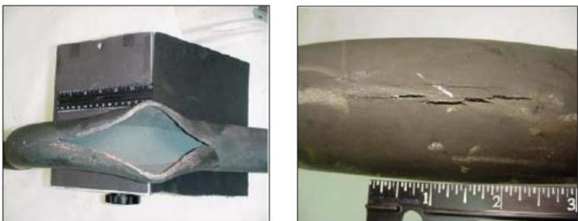
**Slika 16. Pukotine na cijevima pregrijivača izrađenim od čelika P91 [16]**
