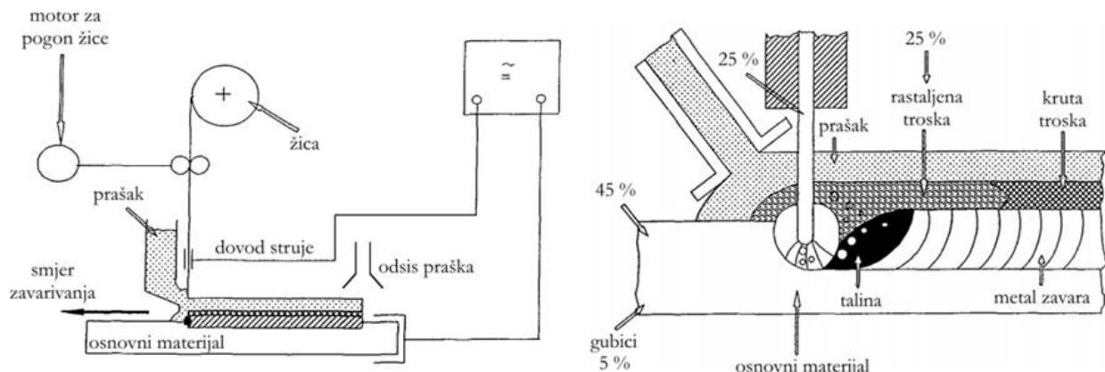
**Slika 19. Shema elektrolučnog zavarivanja pod zaštitom praška (EPP) [19]**
