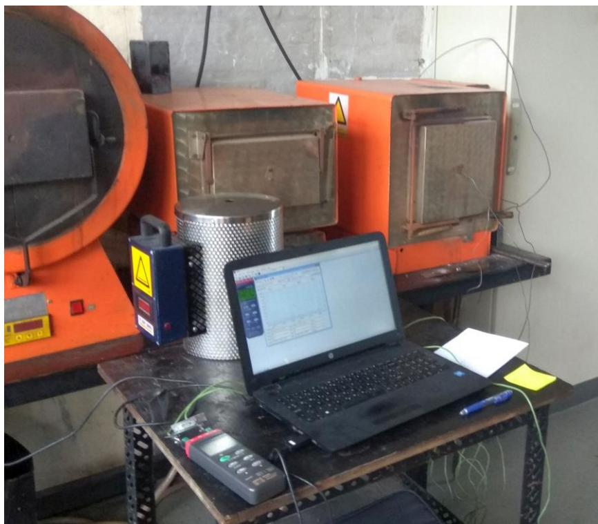
Slika 37. Oprema za provođenje toplinske obrade
