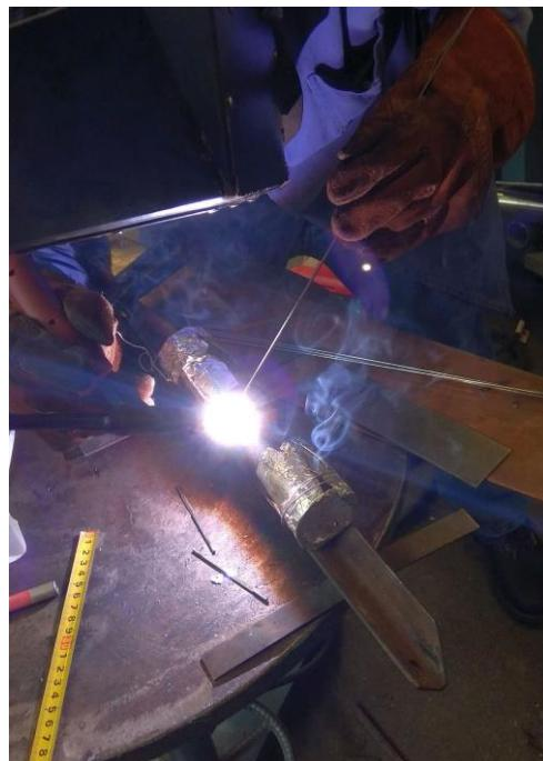
**Slika 33. Zavarivanje cijevi od čelika P91**
