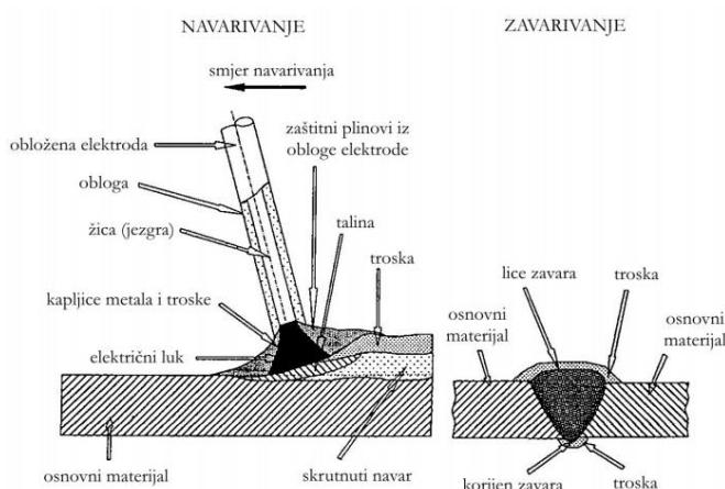
Slika 18. Shematski prikaz REL postupka zavarivanja [19]
