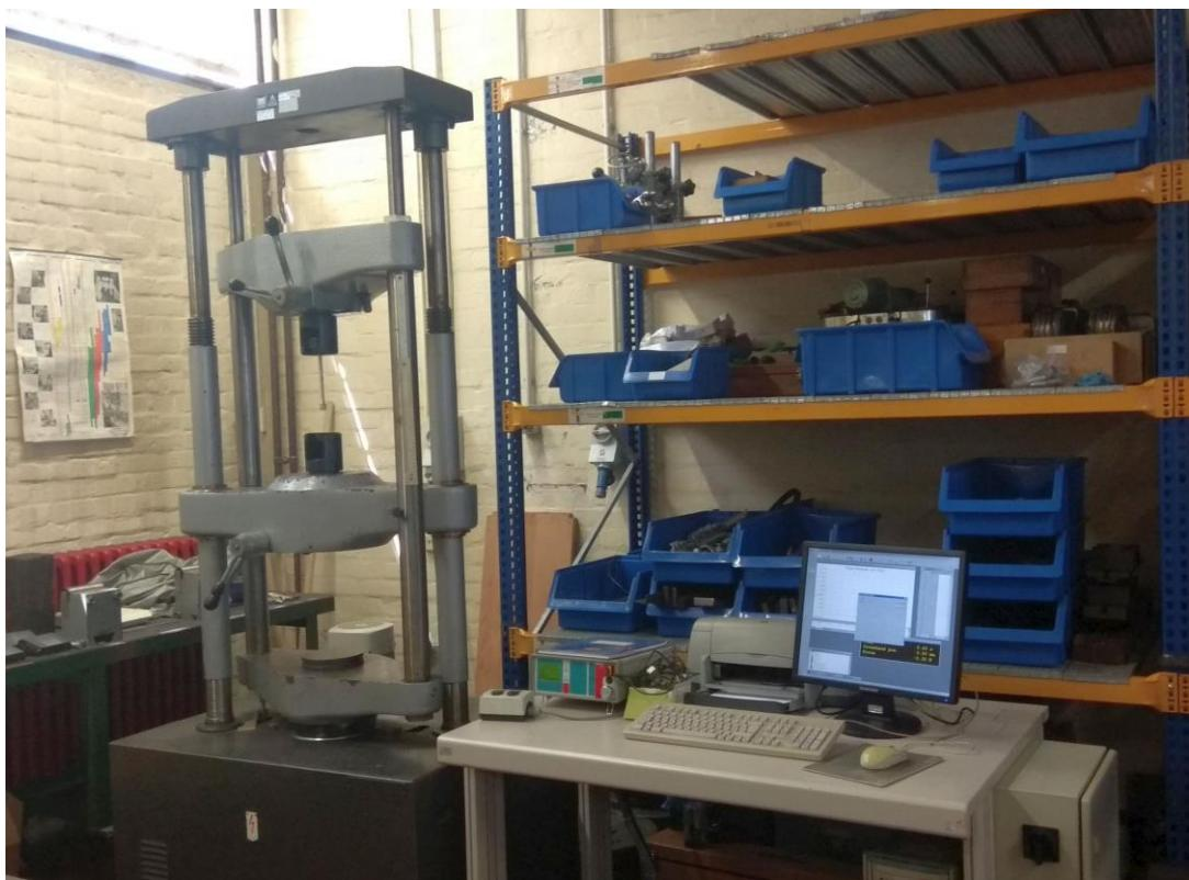
Slika 49. Oprema korištena za provođenje statičkog vlačnog ispitivanje
