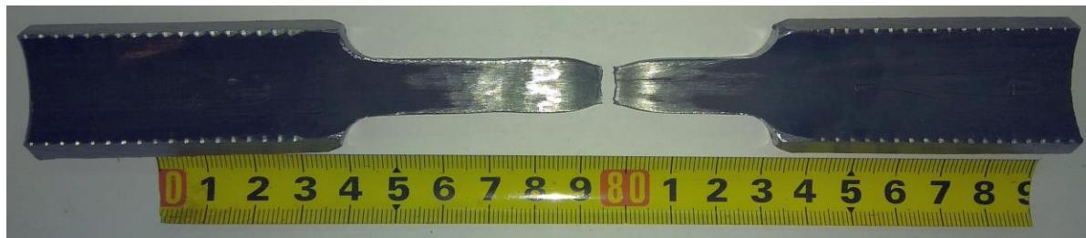
**Slika 52. Uzorak 2 nakon statičkog vlačnog ispitivanja**
