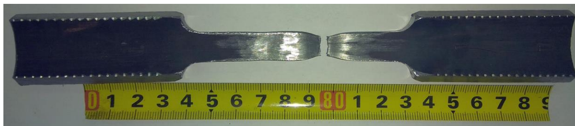
Slika 52. Uzorak 2 nakon statičkog vlačnog ispitivanja
