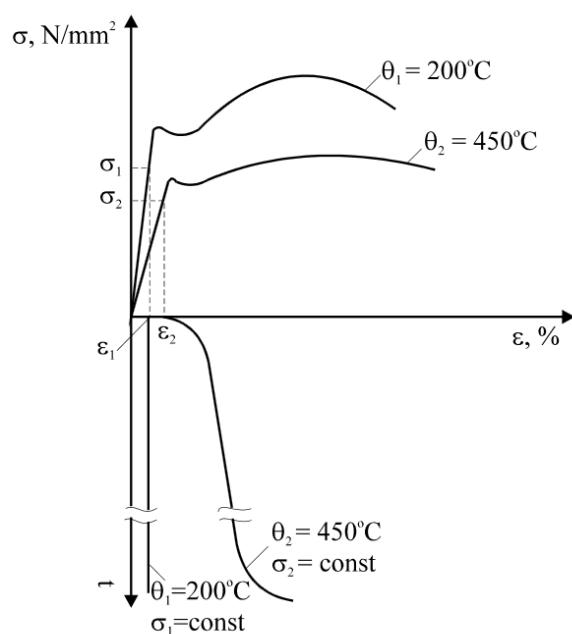
**Slika 3. Dijagrami  $\sigma$ - $\varepsilon$  i "zakrenuti" dijagrami puzanja za dve povišene temperature ispitivanja za isti kotlovske čelik [5]**
