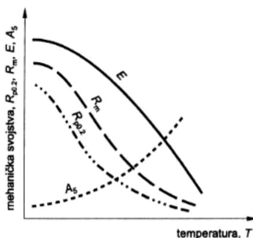
**Slika 5. Promjene mehaničkih svojstava u ovisnosti o temperaturi [1]**
