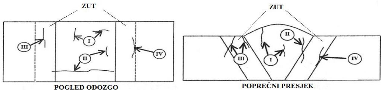
**Slika 15. Shematski prikaz mogućih orijentacija i lokacija pukotina kod zavarenih spojeva čelika P91 [16]**
