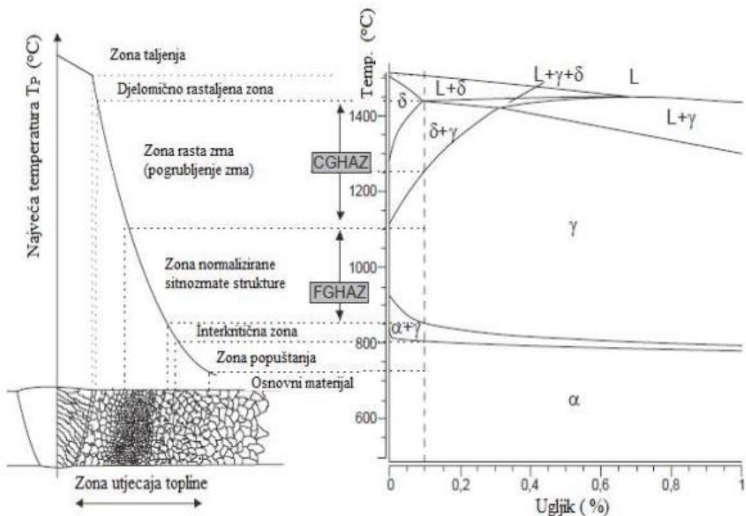
**Slika 14. Promjene u strukturi kod zavarivanja čelika P91 [14]**
