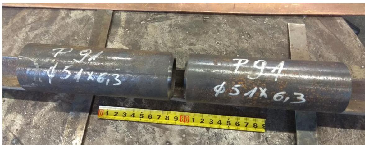
**Slika 27. Izgled cijevi prije zavarivanja**
