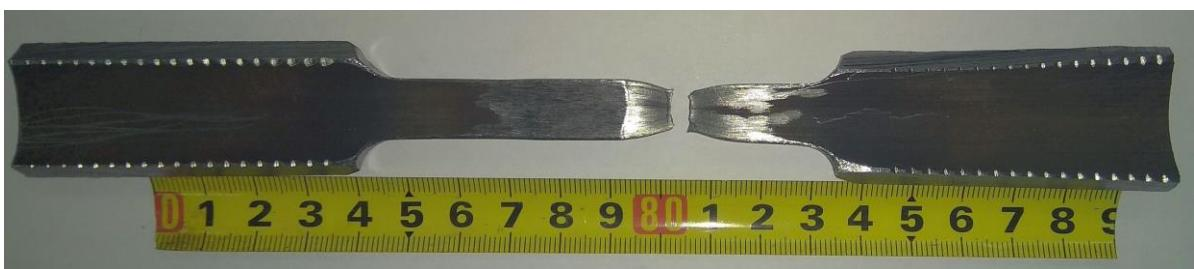
**Slika 51. Uzorak 1 nakon statičkog vlačnog ispitivanja**
