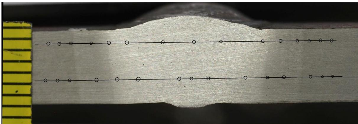
**Slika 47. Makroizbrusak uzorka 1 s označenim točkama mjerena tvrdoće**
