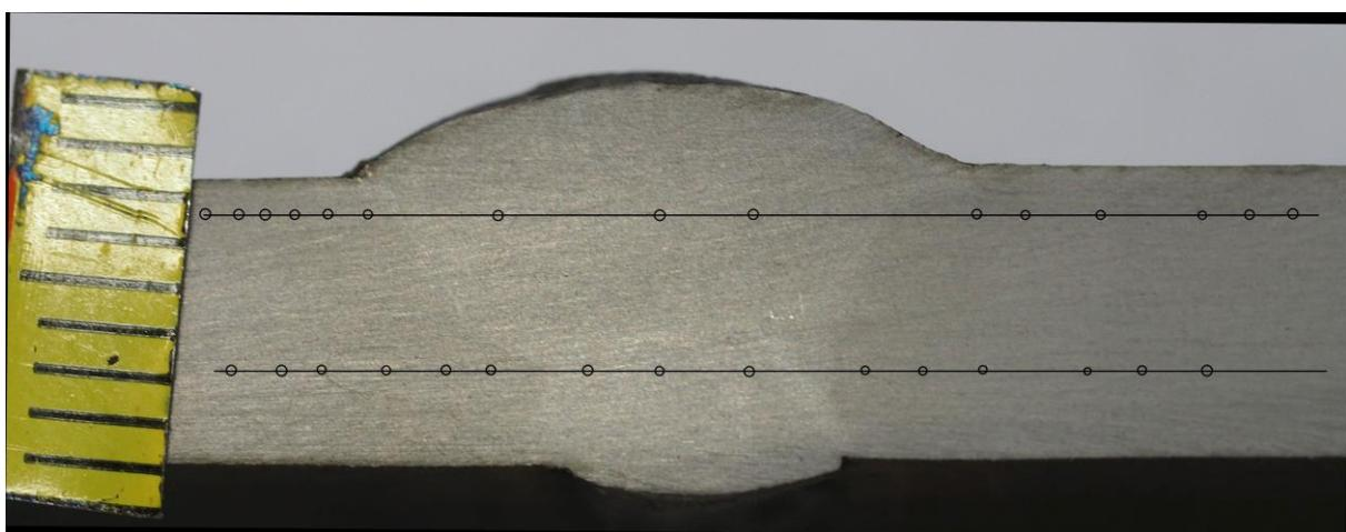
**Slika 48. Makroizbrusak uzorka 2 s označenim točkama mjerena tvrdoće**
