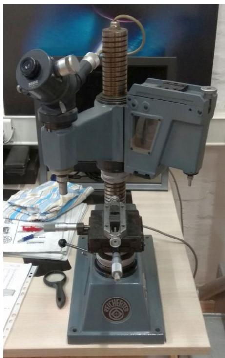
Slika 46. Uređaj za mjerjenje tvrdoće
