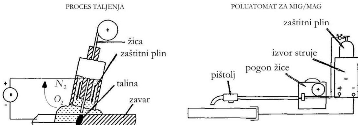
Slika 20. Shematski prikaz procesa i uređaja MIG/MAG zavarivanja [19]
