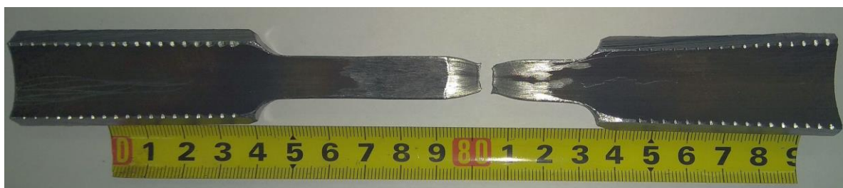
Slika 51. Uzorak 1 nakon statičkog vlačnog ispitivanja
