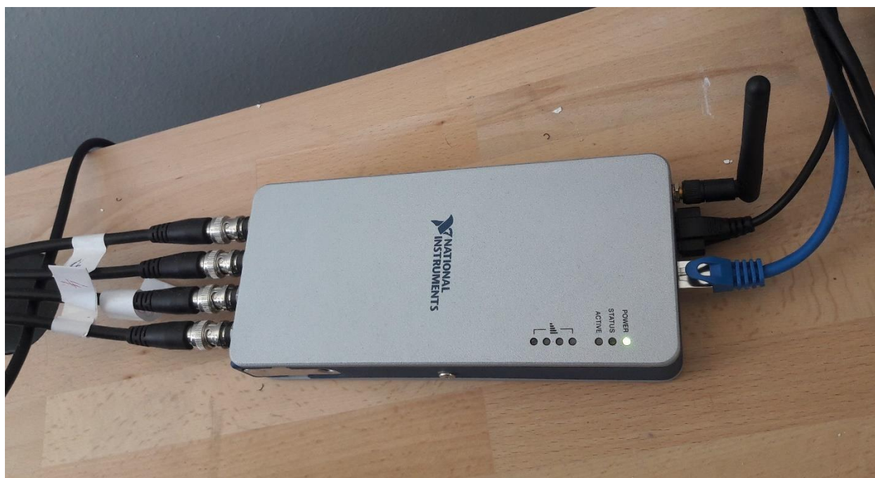
Slika 21. National Instruments NI 9191+NI9234
