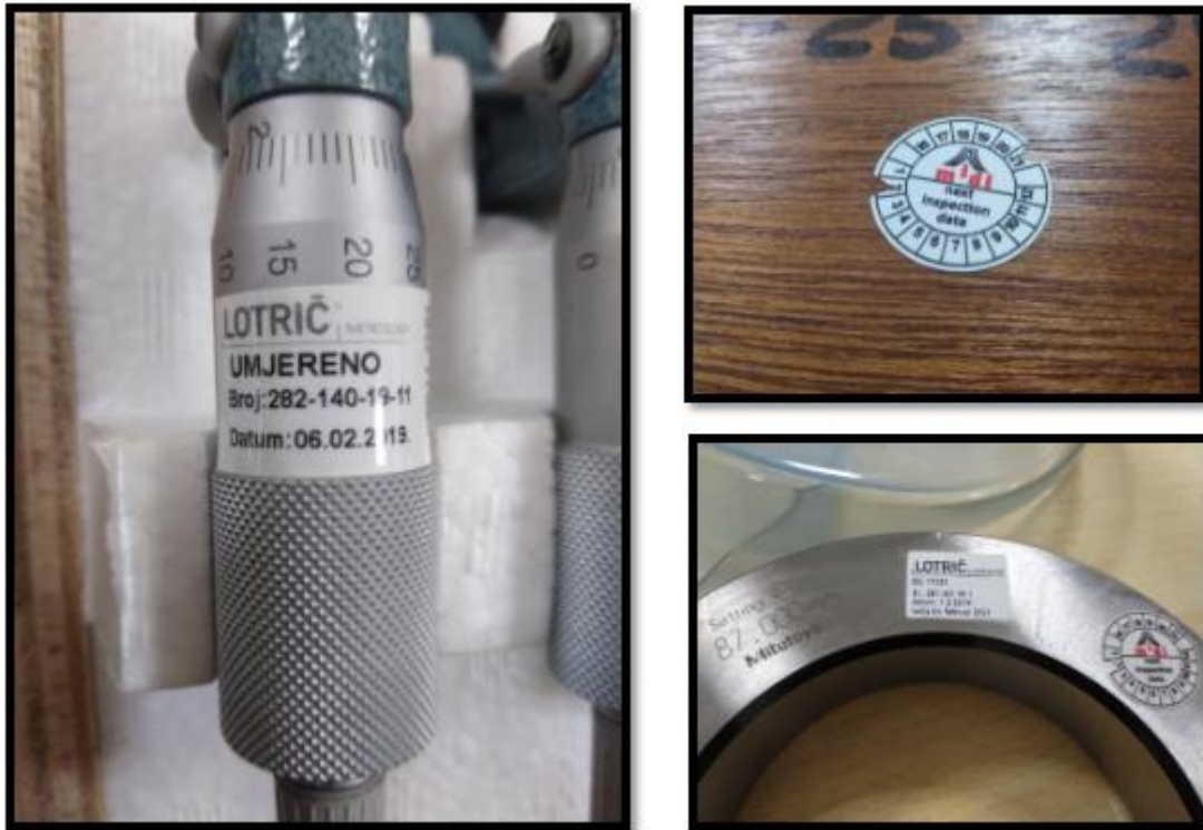
Slika 6 Prikaz oznaka o umjeravanjima mjernih uređaja
