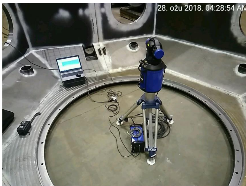
Slika 10 Prikaz trodimenzionalnog mjerenja laserskim uređajem „FARO Tracker“ [4]
