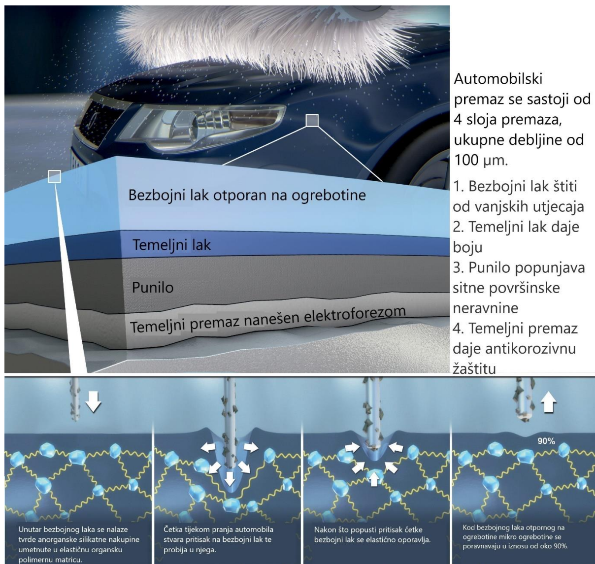
Slika 13. Prikaz elastičnog oporavka bezbojnog laka otpornog na ogrebotine [21]
