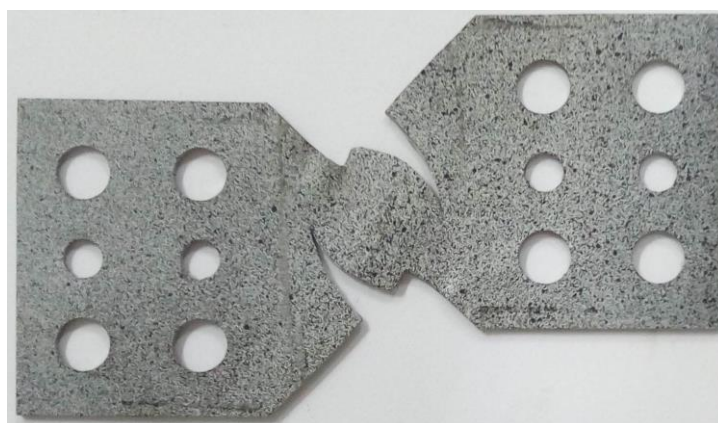
Slika 90. Deformirani ispitni uzorak E3
