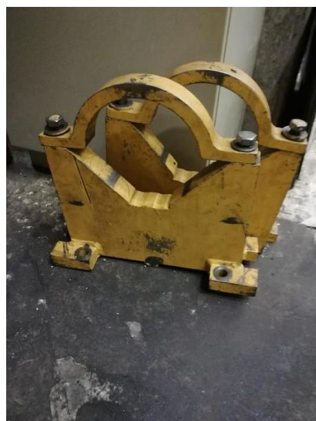
Slika 23. Stezna naprava za cijevi i šipke
