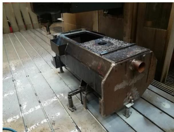
Slika 33. Primjer obrade glodanjem
