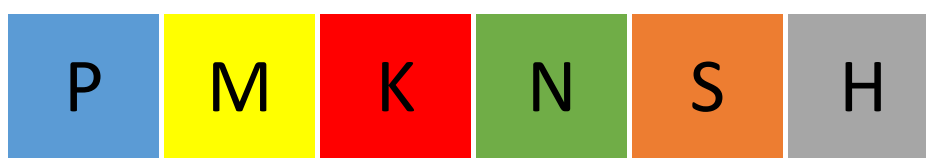
Slika 17. Označavanje reznih alata prema materijalu obratka
