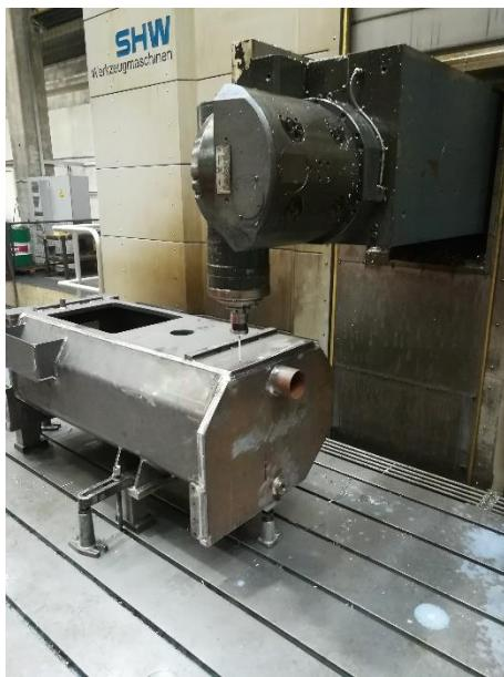
**Slika 30. Mjerenje visine ticalom**
