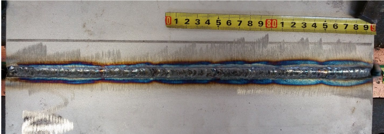
Slika 63. Prikaz prvog prolaza popune nakon zavarivanja, Laboratorij za zavarivanje, FSB, Zagreb
