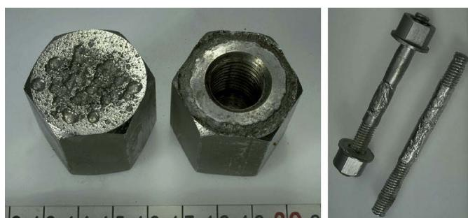
**Slika 3. Prikaz korozije u procijepu legure Hastelloy C-4 [19]**
