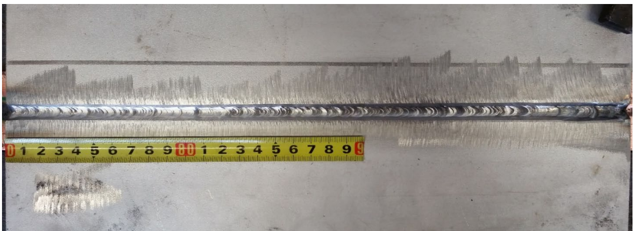
Slika 62. Prikaz korijenskog prolaza s prednje strane zavara nakon čišćenja oksida, Laboratorij za zavarivanje, FSB, Zagreb
