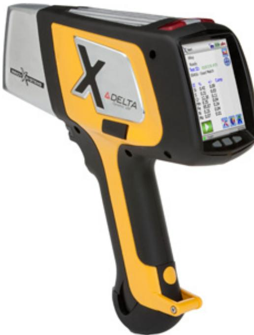
Slika 83. Prikaz uređaja XRF – Olympus [38]
