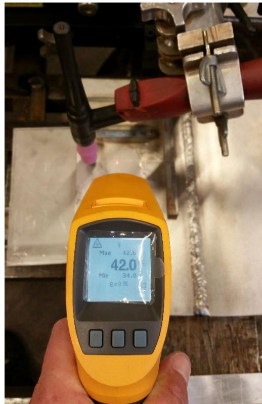
**Slika 50. Prikaz postupka mjerjenja temperature ispitne ploče pomoću uređaja Fluke 568,
