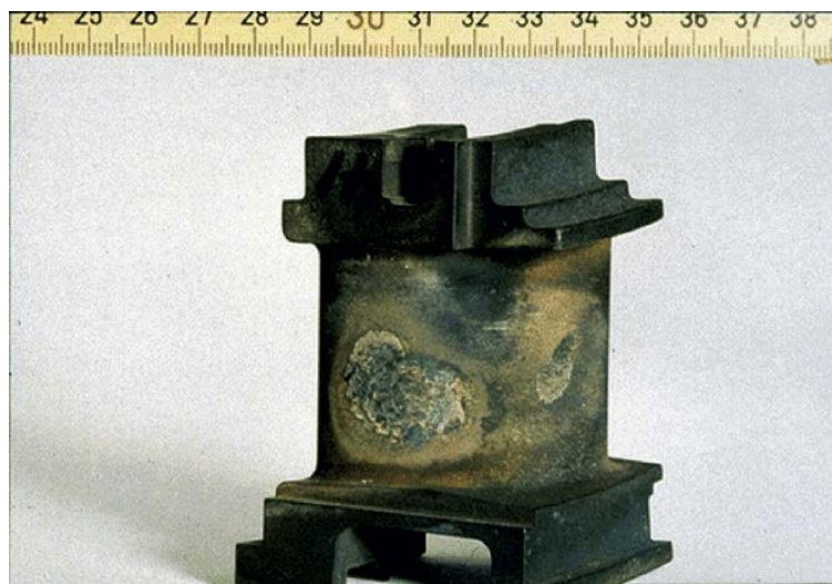
Slika 8. Prikaz nitiranja legure Inconel 738 [19]
