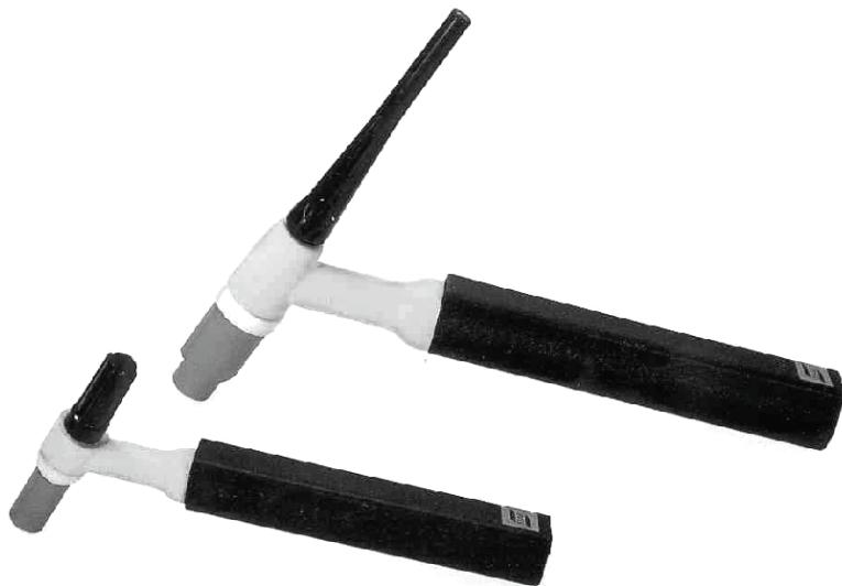
**Slika 30. Prikaz pištolja za ručno TIG zavarivanje [27]**
