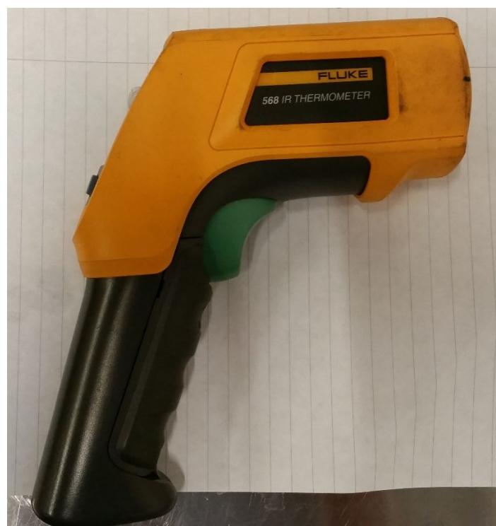
**Slika 51. Prikaz uređaja za mjerjenje temperature, Fluke 568, Laboratorij za zavarivanje, FSB,
