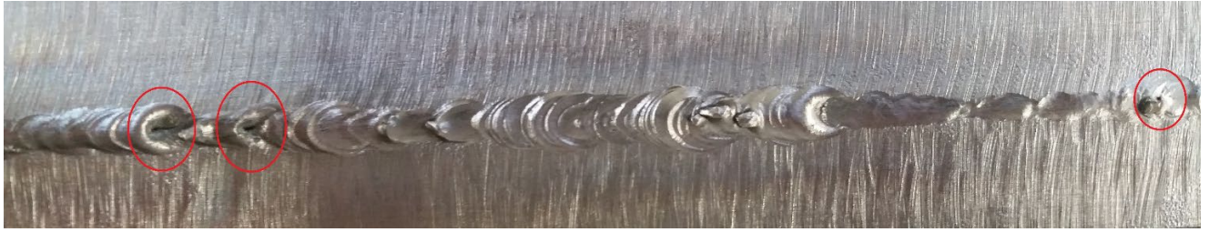
Slika 72. Prikaz pogreške poroznosti korijenskog prolaza, Laboratorij za zavarivanje, FSB, Zagreb
