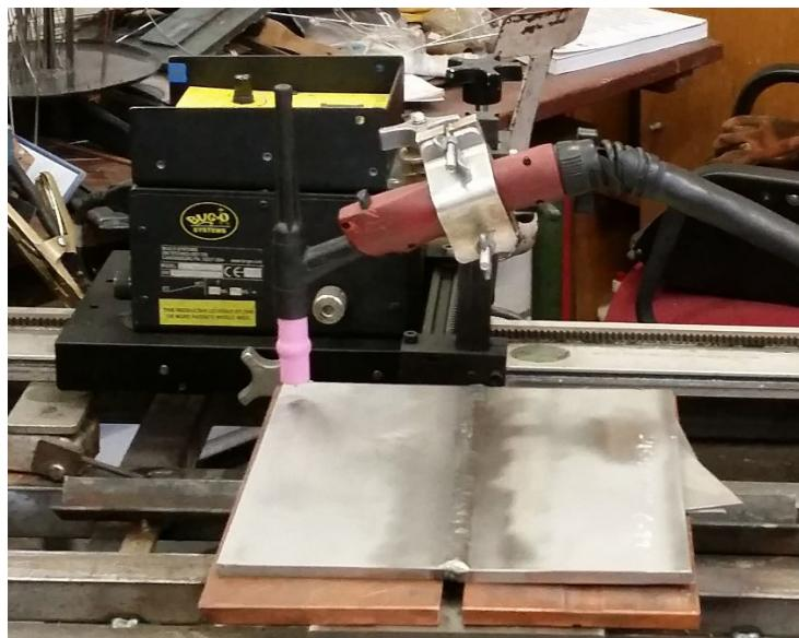
**Slika 47. Prikaz naprave za automatiziranje procesa zavarivanja „BUGO Systems“, Laboratorij za zavarivanje, FSB, Zagreb**
