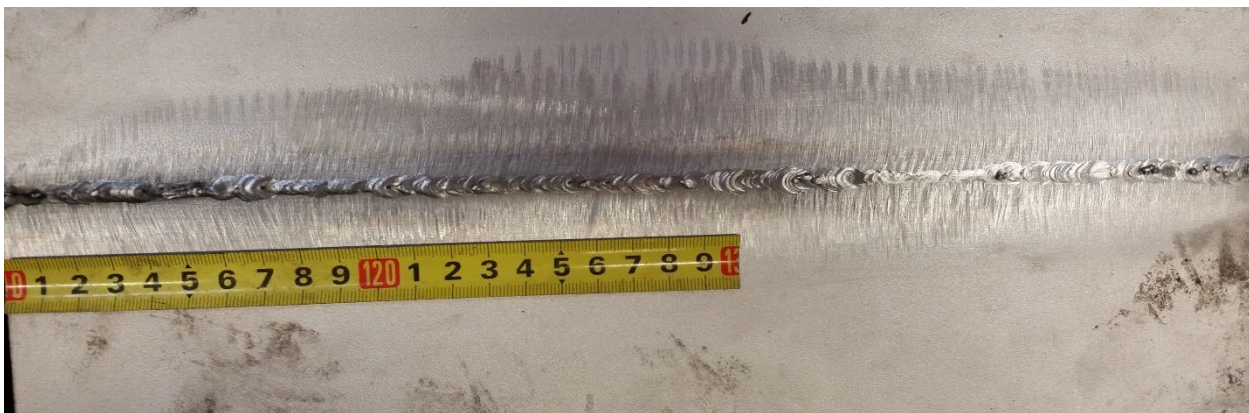
Slika 70. Prikaz korijenskog prolaza sa stražnje strane zavara nakon čišćenja oksida, Laboratorij za zavarivanje, FSB, Zagreb
