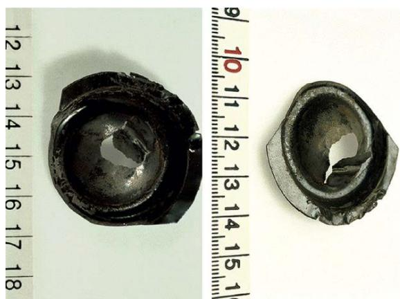
Slika 7. Prikaz napetosne korozije tehnički čistog nikla [19]
