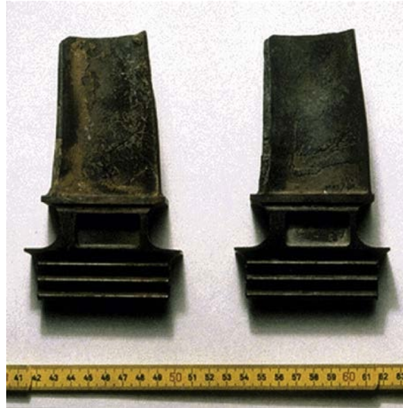
Slika 10. Prikaz sulfidizacije legure Rene 77 [19]
