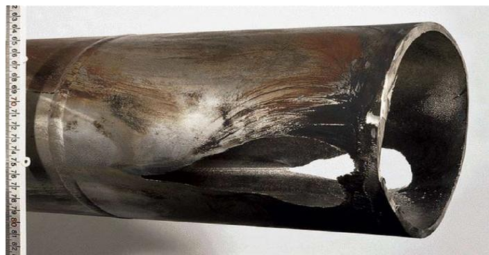
**Slika 6. Prikaz erozijske korozije legure Hastelloy C-276 [19]**
