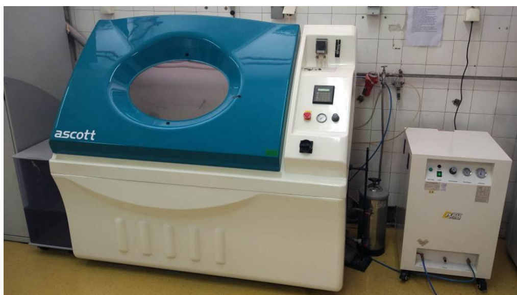
Slika 67. Slana komora Ascot S450 u Laboratoriju za zaštitu materijala
