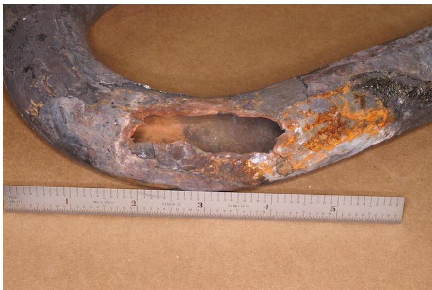
Slika 28. Oštećenje uzrokovano erozijskom korozijom [34]
