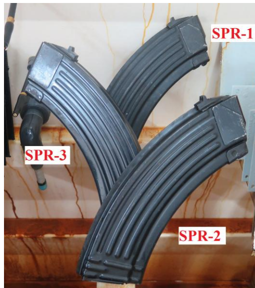
Slika 68. Uzorci SPR-1,2,3 postavljeni u slanu komoru
